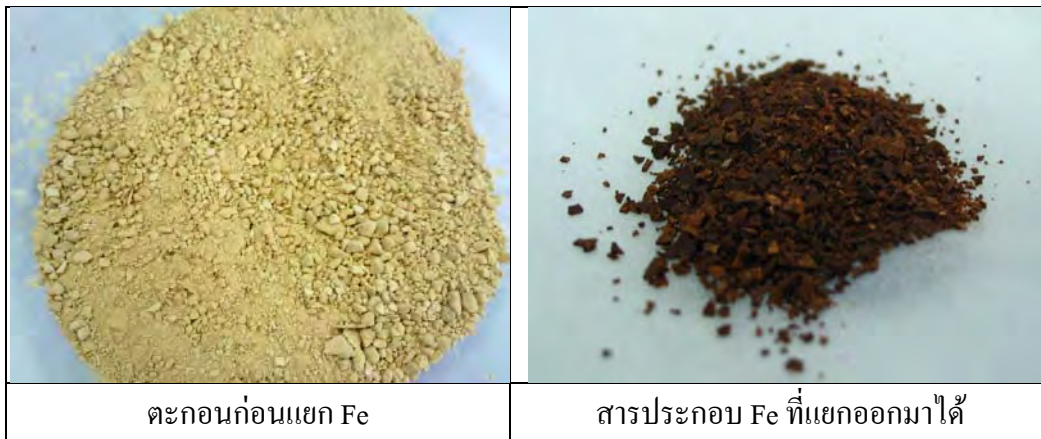
รูปที่ 4.6 ลักษณะตะกอนสารประกอบสังกะสีก่อนการแยก Fe (ซ้าย) และลักษณะสารประกอบ Fe ที่แยกออกมาได้
