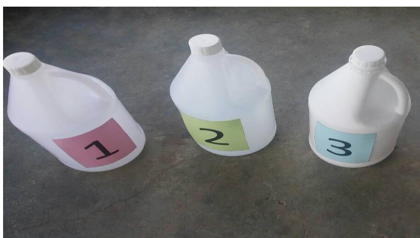
รูปที่ 7. 3 ตัวอย่างการจัดทำหมายเลขแสดงลำดับการผสมสารเคมีบนขวดสารเคมี
