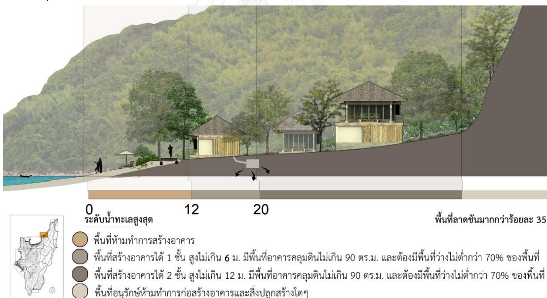
ภาพที่ 63 แสดงการกำหนดระยะถอยร่นในการสร้างอาคาร และการปลูกต้นไม้ใหญ่และไม่พุ่มหน้าอาคาร และระหว่างอาคารเพื่อพรางสายตา
