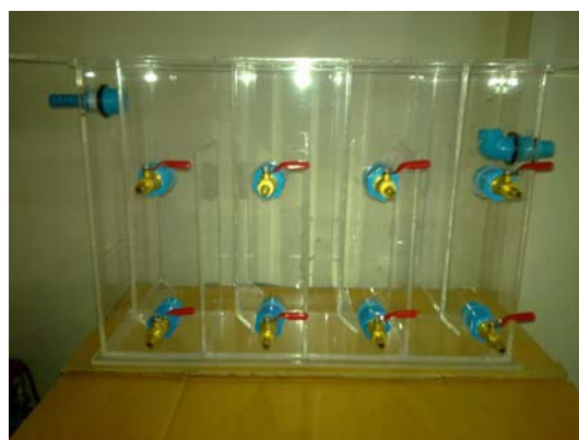
ภาพที่ 3.3 ถังปฏิกรณ์เอปเปอาร์ที่ใช้ในการทดลอง
