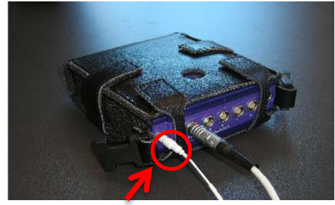
ภาพที่ 3 ต่อสายกราวด์ (วงกลม) และสายเคเบิล
