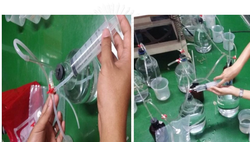
รูปที่ 14 การเก็บตัวอย่างก๊าซชีวภาพโดยการแทนที่ของน้ำ
