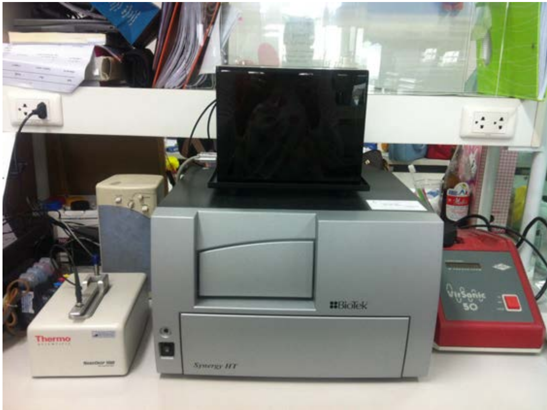
รูปที่ 6: แสดงเครื่อง Microplate reader ที่ใช้ในการวัดค่าดูดกลืนแสงฟลูออเรสเซนต์
