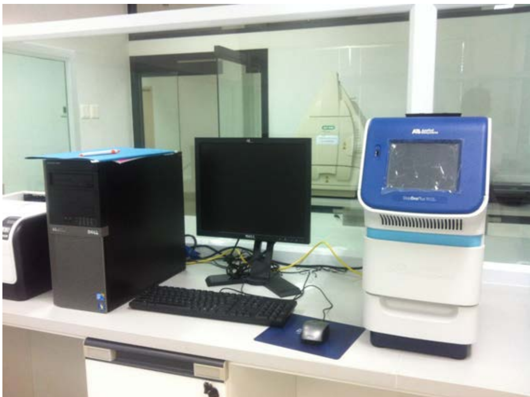
รูปที่ 8: แสดงเครื่อง StepOnePlus™ ที่ใช้ในการทำ Real-time PCR
