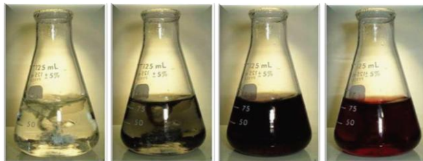
รูปที่ 2: แผนภาพแสดงการสังเคราะห์อนุภาคทองคำระดับนาโนเมตรจากสารละลาย \text{HAuCl}_4 และ Sodium citrate Dihydrate ด้วยปฏิกิริยา Reduction ในอุณหภูมิที่เหมาะสม
