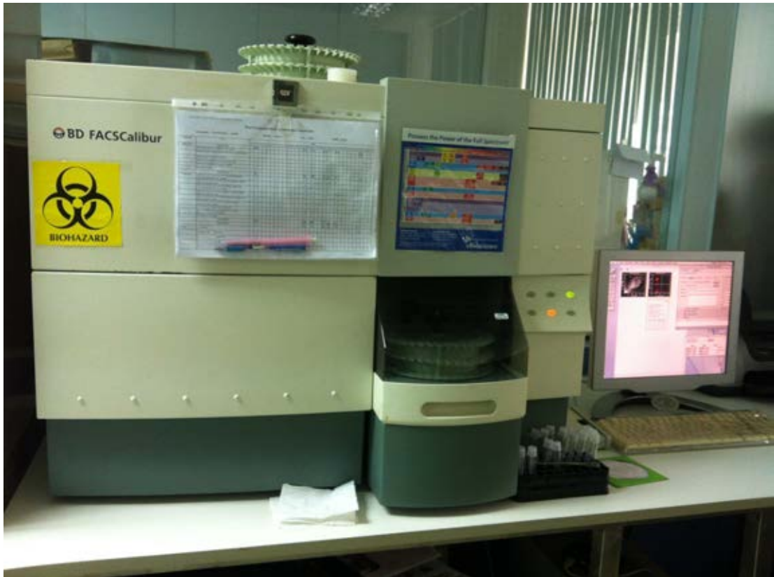
รูปที่ 7: แสดงเครื่อง Flow cytometer ที่ใช้ในการวัดหาความเข้มของสี CFSE ที่อยู่ในเซลล์
