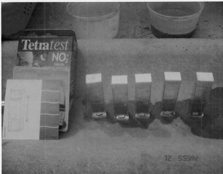
รูปที่ 31 ชุดตรวจคุณภาพน้ำทะเลแบบเปรียบเทียบสี ที่มา : ผู้เขียน
