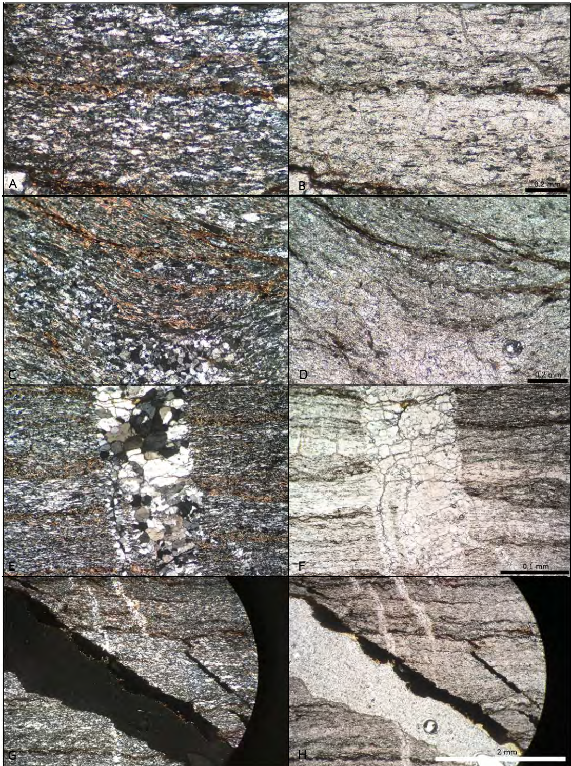
รูป 3.10 A-B แร่ควอตซ์และแร่ไมก้าเรียงตัวตามริ้วขนานและแกนยาวของแร่ขนานกับแนวริ้วขนาน C-D ลักษณะริ้วขนานแบบ anastomosing E-F สายแร่ควอตซ์ชุดที่สองวางตัวตัดแนวริ้วขนานและไม่พบการเปลี่ยนลักษณะของเมดแร่ควอตซ์ G-H แนวรอยแตกตัดผ่านริ้วขนานและสายแร่ควอตซ์ชุดที่สอง A, C, E, G (XPL) B, D, F, H (PPL)
