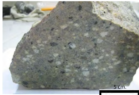
รูปที่ 3.4 ตัวอย่าง ST 2 เป็นหินโผล่บริเวณถนนเขาหลังวัดวัดเขาหินลาด ( 13^{\circ} 6' 29.088'' N, 101^{\circ} 7' 13.256'' E) เป็นหินแกรนิตที่มีแร่เฟลด์สปาร์และไบโอไทต์เด่น ผลึกขนาดปานกลาง พบลักษณะเนื้อดอกของแร่เฟลด์สปาร์ มีการผุสูง
