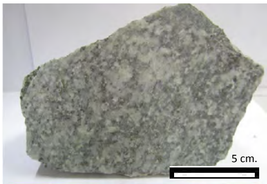
รูปที่ 3.13 ตัวอย่าง ST11 เป็นหินหล่น (loose block) บริเวณเขาหลวงเตี้ยล่าง ( 12^{\circ} 47' 4.780'' N, 101^{\circ} 24' 48.982'' W) หินแกรนิตที่มีแร่ควออร์ตซ์ และไบโอไทต์เด่น มีผลึกขนาดปานกลางถึงใหญ่ แสดงร้าวลายเล็กน้อย
