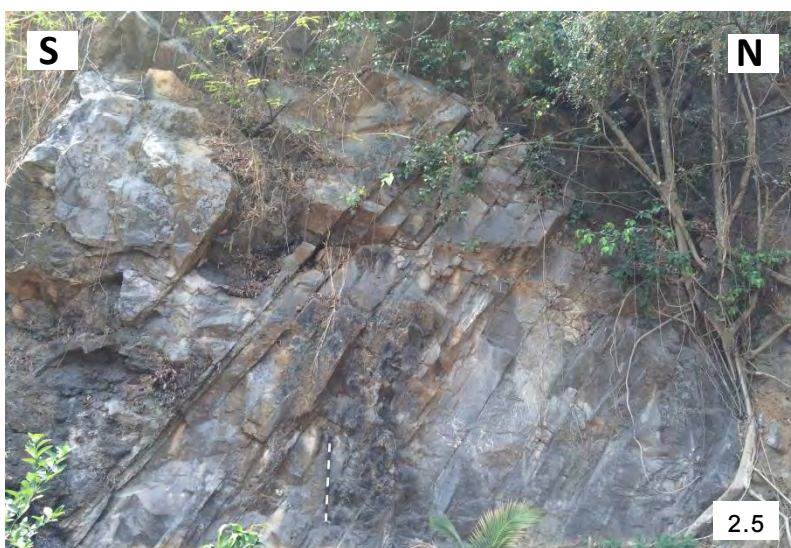
รูปที่ 2.5 หินปูนสีเทาบริเวณจุดศึกษาที่ 2 หนาทั้งหมด 8 เมตร ทิศทางการวางตัวของชั้นหินในแนว 67/65S
