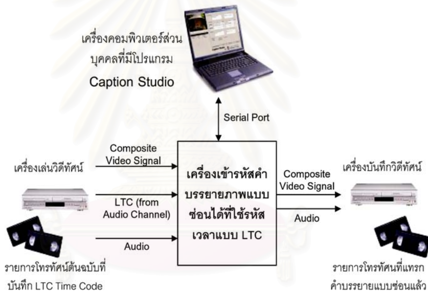
รูปที่ 3.1 การต่อเชื่อมเครื่องเข้ารหัสคำบรรยายภาพแบบซ่อนได้ที่มีรหัสเวลา LTC
