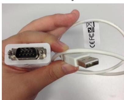
รูปที่ 1.26 สายเชื่อมระหว่างเครื่องมือวัดฝุ่นแบบพกพากับคอมพิวเตอร์
