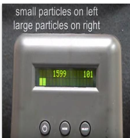
รูปที่ 1.29 การแสดงผลของขนาดฝุ่นละอองที่เครื่องมือสามารถวัดได้
