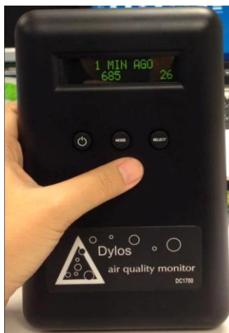
รูปที่ 1.32 เครื่องมือแสดงผลการเก็บข้อมูลในโหมดที่ผู้ทดลองกำหนดไว้ข้างต้น
