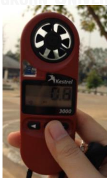
รูปที่ 5.15 เครื่องมือวัดความเร็วลม (Kestrel 3000) สำหรับใช้ในการวัดความเร็วลม
