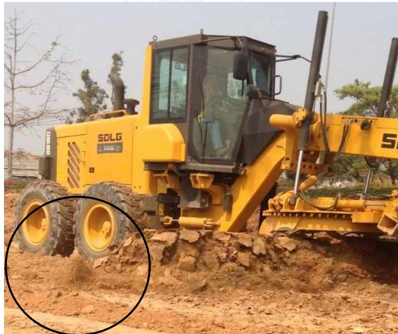
รูปที่ 4.5 แหล่งกำเนิดของฝุ่นละอองจากกิจกรรมเกลี่ยดินของรถเกลี่ยดิน (Grader)
