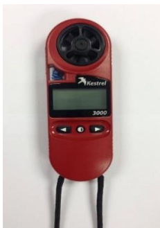
รูปที่ 3.3 เครื่องมือวัดความเร็วลม Kestrel 3000
