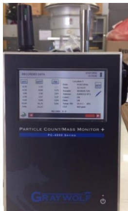
รูปที่ 3.6 เครื่องมือวัดอนุภาคอากาศ (Particle Count/Mass Monitor)
