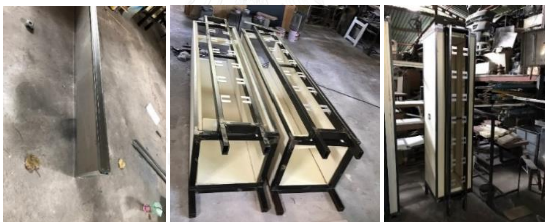
ภาพที่ 3.8 โครงเหล็กหลังประกอบกับโคมโพลียูรีเทนสำหรับกล่องทดลอง และ ผนังต้นแบบแผ่นสมาร์ทบอร์ดหนา 1 เซนติเมตร
