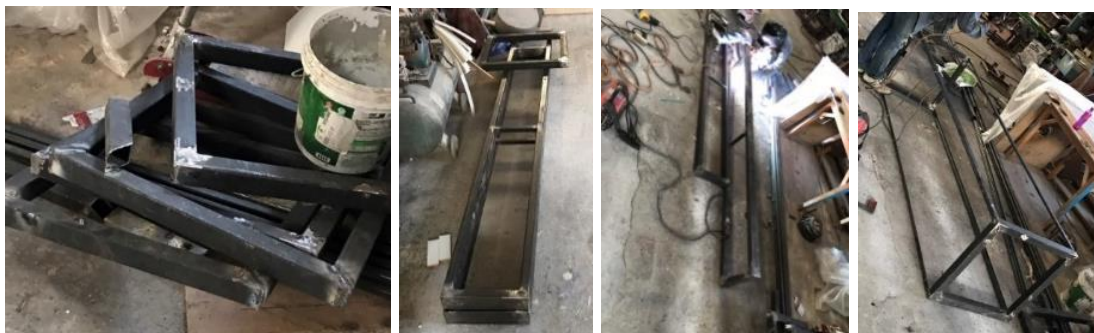
ภาพที่ 3.7 การประกอบโครงเหล็กสำหรับกล่องทดลอง
