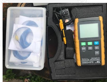
ภาพที่ 3.2 ส่วนประกอบภายนอก ของ 12 Channels Temperature Recorder และสาย thermocouple type K
