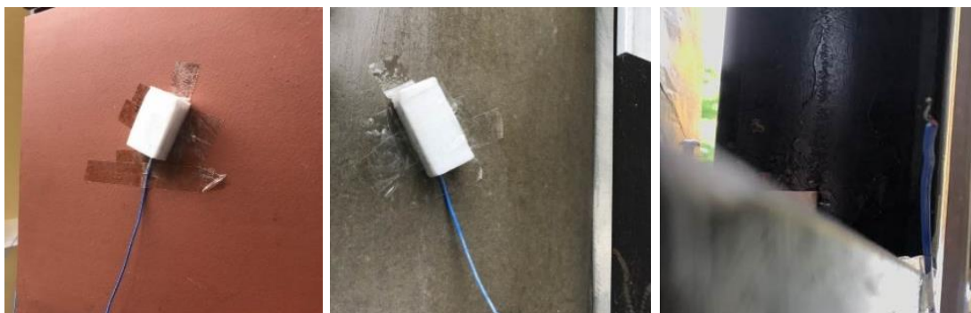
ภาพที่ 3.11 การติดตั้งเซ็นเซอร์เก็บข้อมูลวัดอุณหภูมิผิวผนังด้านนอกของผนังต้นแบบ กับผนังทดสอบ และ อุณหภูมิช่องว่างอากาศภายในผนัง (ตามลำดับ)
