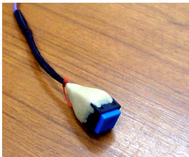
รูปที่ 6.12 รูปแสดงสวิทซ์ปุ่มกดที่ใช้สั่งให้โปรแกรมซียู-ซีเอ็มเอ็มบันทึกข้อมูล
