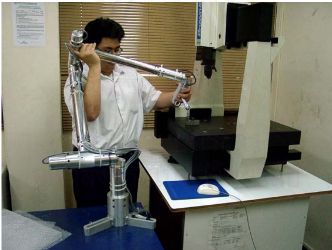
รูปที่ 5.13 รูปแสดงตำแหน่งของซียู-ซีเอ็มเอ็มและซีเอ็มเอ็มบราวน์แอนด์ชาร์ปขณะทำการทดลอง
