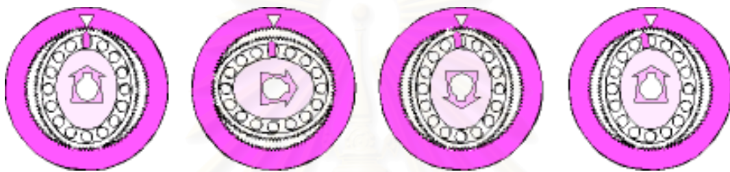
รูปที่ 3.5 แสดงการหลักการทำงานของฮาร์โมนิคไดรฟ์
