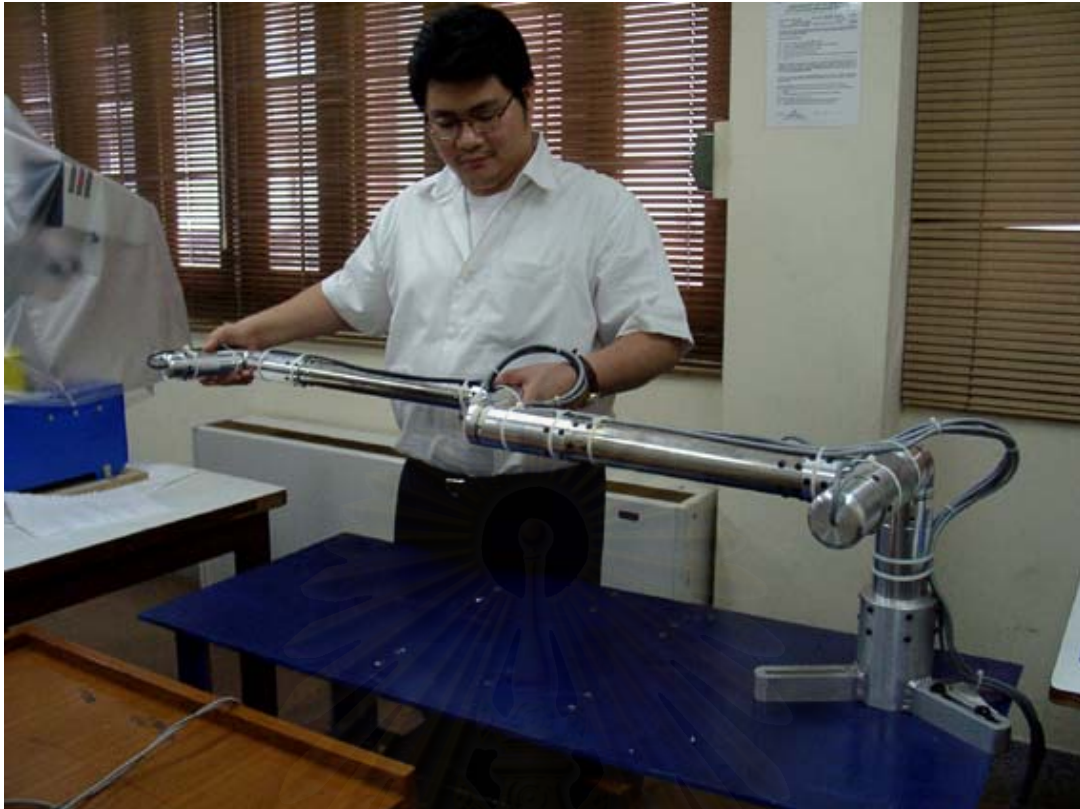
รูปที่ 5.14 รูปแสดงตำแหน่งของการตั้งค่าศูนย์ให้กับเอนโคเดอร์ของทุกข้อต่อ
