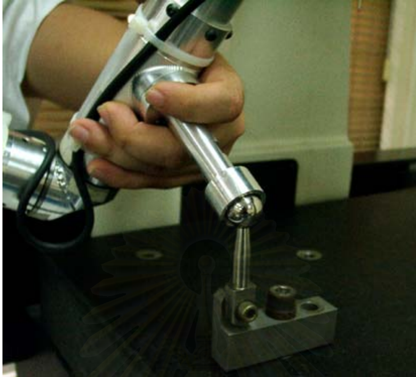
รูปที่ 8.12 รูปแสดงการวัดตำแหน่งทรงกลมที่ตำแหน่งที่ 2 (ด้านซ้าย)
