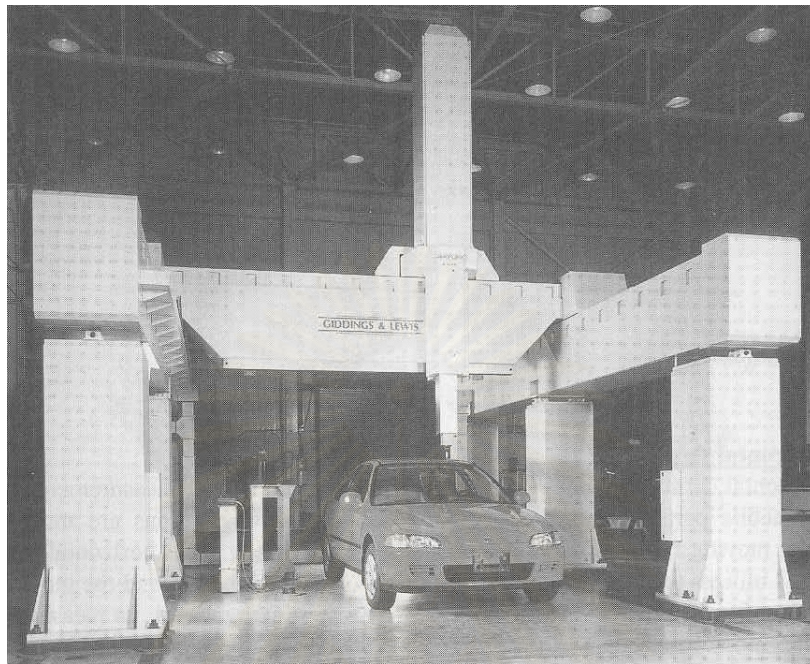
รูปที่ 2.6 รูปแสดงซีเอ็มเอ็มแบบแกนทรีที่มีระบบการชดเชยแบบออนไลน์ ของบริษัท Sheffield Measurement
