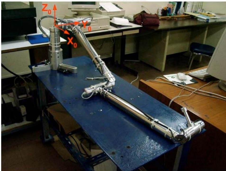
รูปที่ 8.5 รูปแสดงตำแหน่งแกนศูนย์ของซียู-ซีเอ็มเอ็ม
