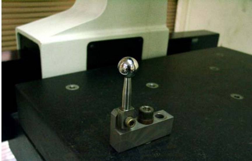
รูปที่ 5.11 รูปแสดงทรงกลมสอบเทียบของซีเอ็มเอ็มบราวน์แอนด์ชาร์ป
