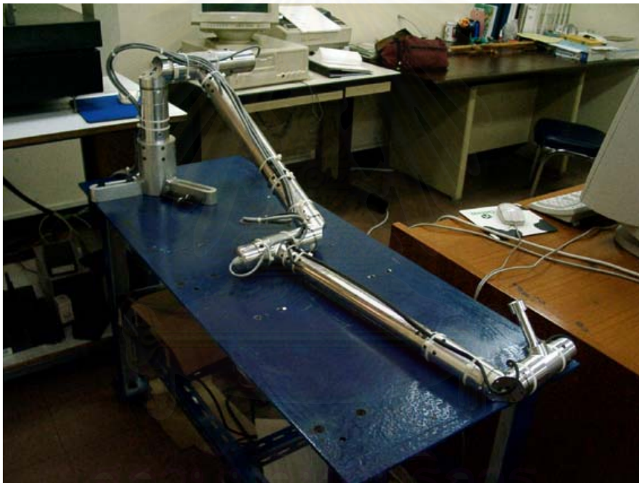
รูปที่ 8.1 รูปแสดงเครื่องวัดพิกัด 3 มิติ แบบข้อต่อ 6 แกน (ซียู-ซีเอ็มเอ็ม) ที่สร้างขึ้น
