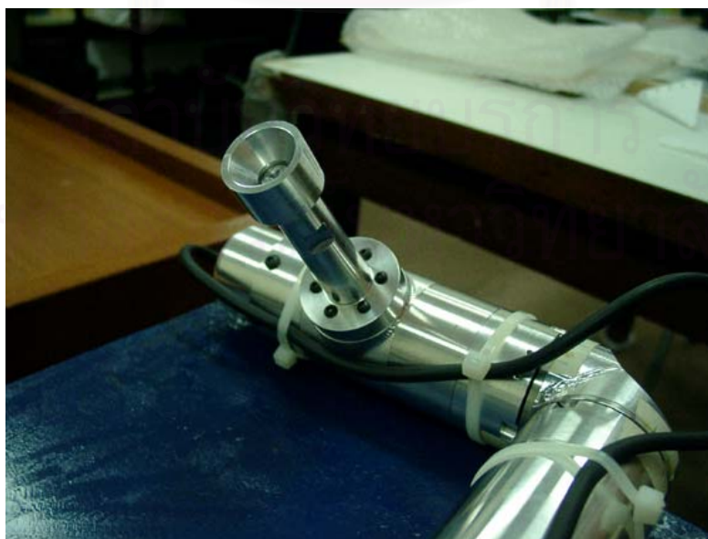
รูปที่ 8.9 รูปแสดงหัววัดของซียู-ซีเอ็มเอ็มที่มีลักษณะเป็นทรงกรวย
