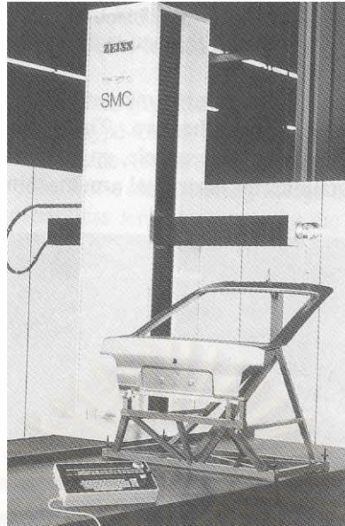
รูปที่ 2.5 รูปแสดงซีเอ็มเอ็มแบบฮอริซอนทอลอาร์มขณะวัดพิคัดขึ้นส่วนประตูดยยนต์ ของบริษัท Carl Zeiss
