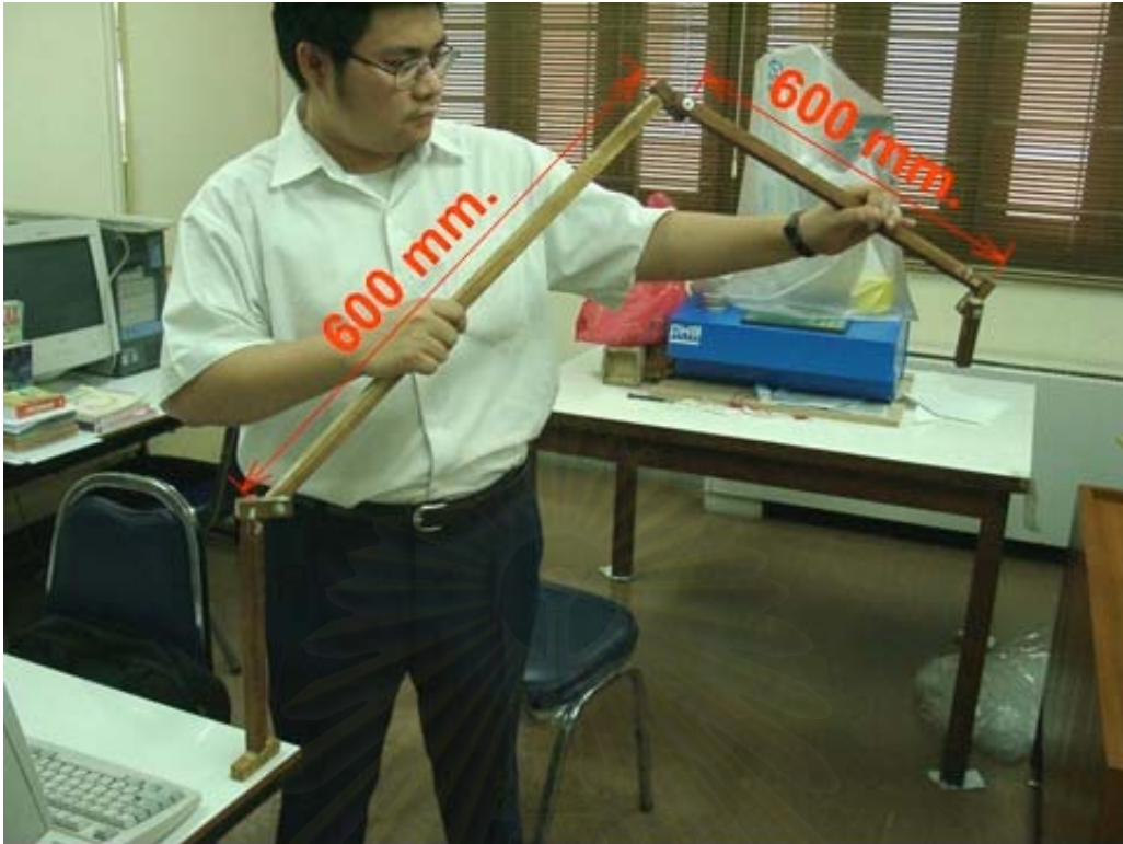
รูปที่ 5.5 รูปแสดงแบบจำลองของแขนกลซียู-ซีเอ็มเอ็ม
