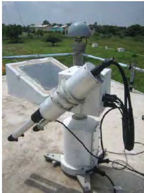
รูปที่ 2 แสดงเครื่อง i-sky radiometer ณ สถานีวิจัยชั้นบรรยากาศ อ.พิมาย จ.นครราชสีมา
