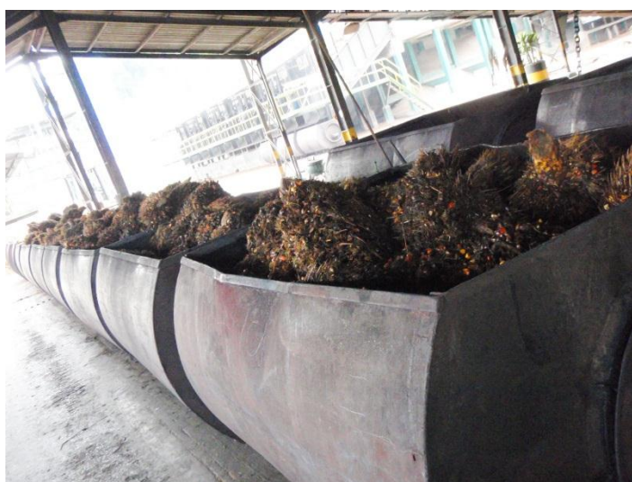
รูปที่ 2.1.2: ทะลายปาล์มน้ำมันที่ถูกนึ่งด้วยไอน้ำร้อนก่อนจะเข้ากระบวนการสกัดเมล็ด
