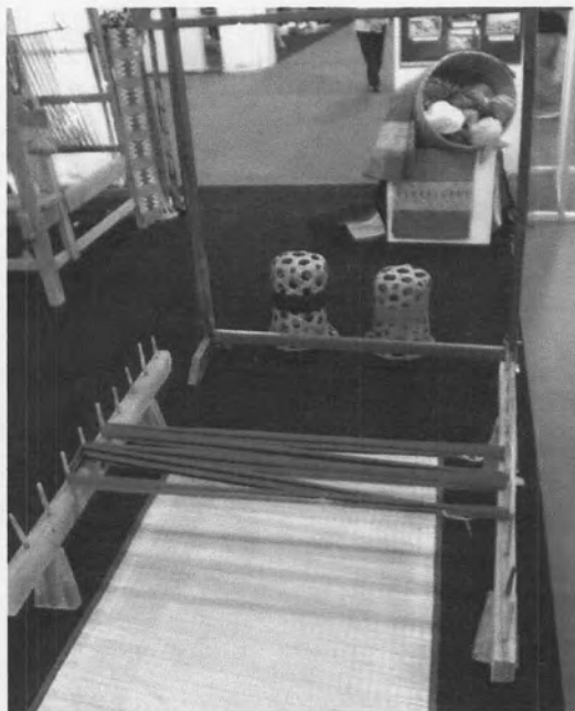
รูปที่ 3.18 อุปกรณ์ที่ใช้ในการเตรียมเส้นยืน
