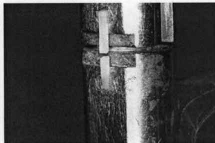
รูปที่ 20 แสดงการแตกหักของชิ้นงานหลังให้แรงดึงด้วย เครื่องทดสอบสากลระบบไฮดรอลิกอินสตรอน
