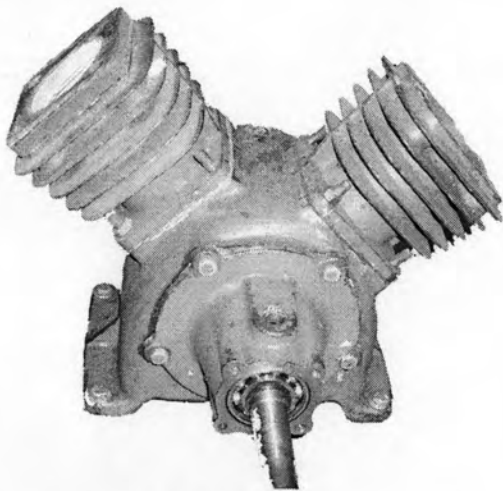
รูปที่ ๘- 5 เครื่องอัดอากาศ
