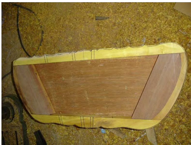
ภาพการเลื่อยโครงขิมด้วยเครื่องเลื่อยไฟฟ้า
