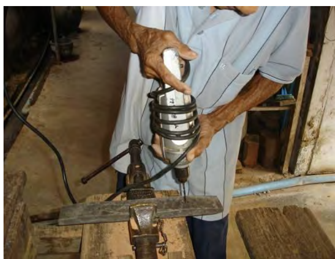
ภาพการเจาะรูขนาดที่หนีบนแม่แรงปากกา
