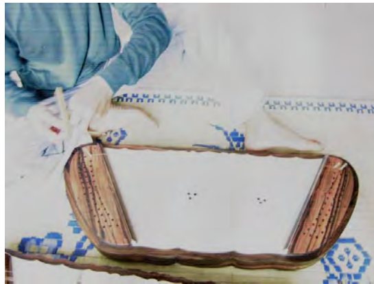
ภาพการติดตั้งหย่องหนุนสายและการใส่รูดทองเหลือง
