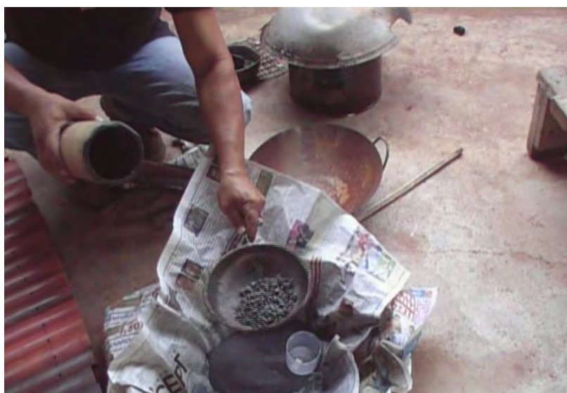
ภาพการร่อนตะกั่วในตะแกรงเหล็ก
