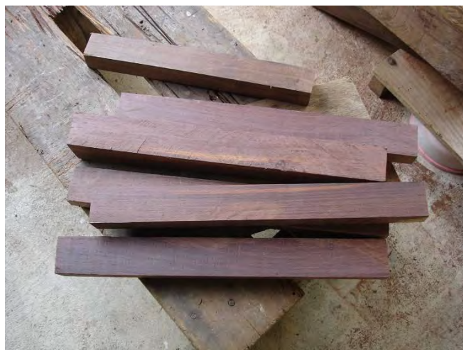
ภาพการเตรียมไม้และการผ่าลูกระนาด
