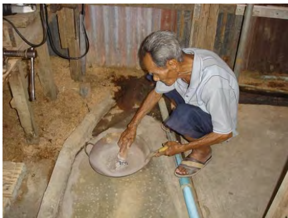
ภาพการใช้ขี้เถ้าโรยบนตะกั่วและการคั่วบดตะกั่ว
