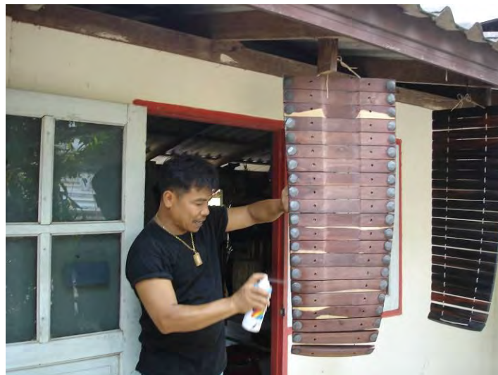
ภาพการฉีดแล็กเกอร์สเปรย์เคลือบผิวลูกระนาด
