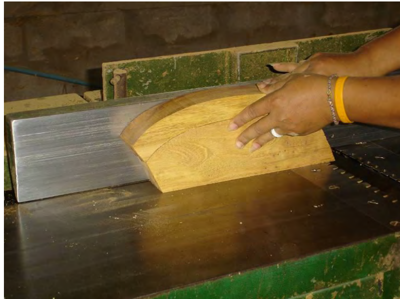
ภาพการไสแก้มจิมให้เรียบด้วยกบไฟฟ้า
