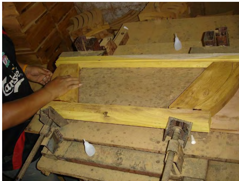
ภาพการประกอบโครงจิมเข้าด้วยกันด้วยกาวร้อน
