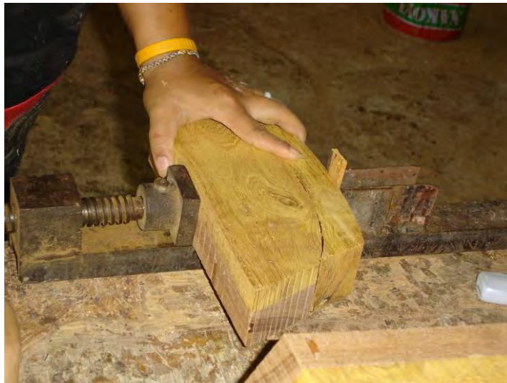
ภาพการประกอบแก้มขิมและไม้ประกบด้วยกาวร้อน
