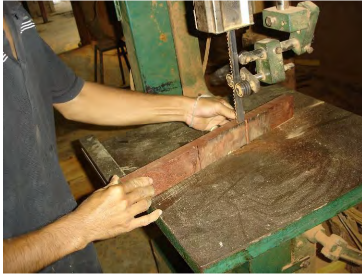
ภาพการบากท้องผืนโดยใช้เครื่องเลื่อยไฟฟ้า
