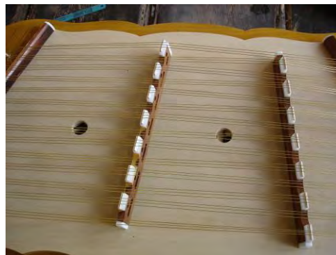
ภาพการติดตั้งหย่องบังคับเสียง
