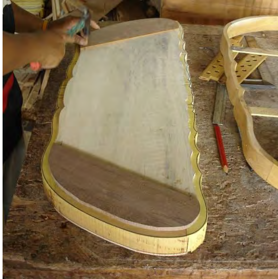
ภาพการประกอบแผ่นปิดหน้าจิมและแก้มจิมด้วยตะปู
