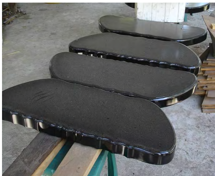
ภาพฝาขิมที่ได้รับการขัดแต่งและพ่นสีเคลือบผิวไม้แล้ว
