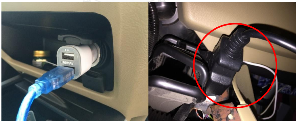
รูปที่ 3.5 การติดตั้งเชื่อมโยงอุปกรณ์ OBD กับตัวรถ
