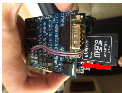
รูปที่ 3.3 การติดตั้งอุปกรณ์ OBD
