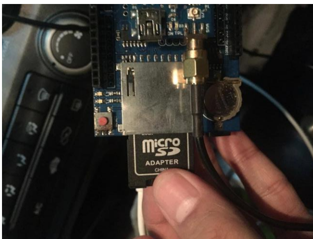
รูปที่ 3.10 การเสียบแท่งบันทึกลงในอุปกรณ์ GPS Logger
