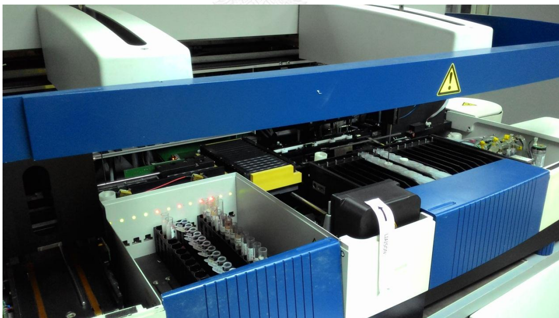
รูปที่ 23 แสดงการทำงานของเครื่องมือในการตรวจวัดค่าระดับ 25-hydroxyvitamin D
