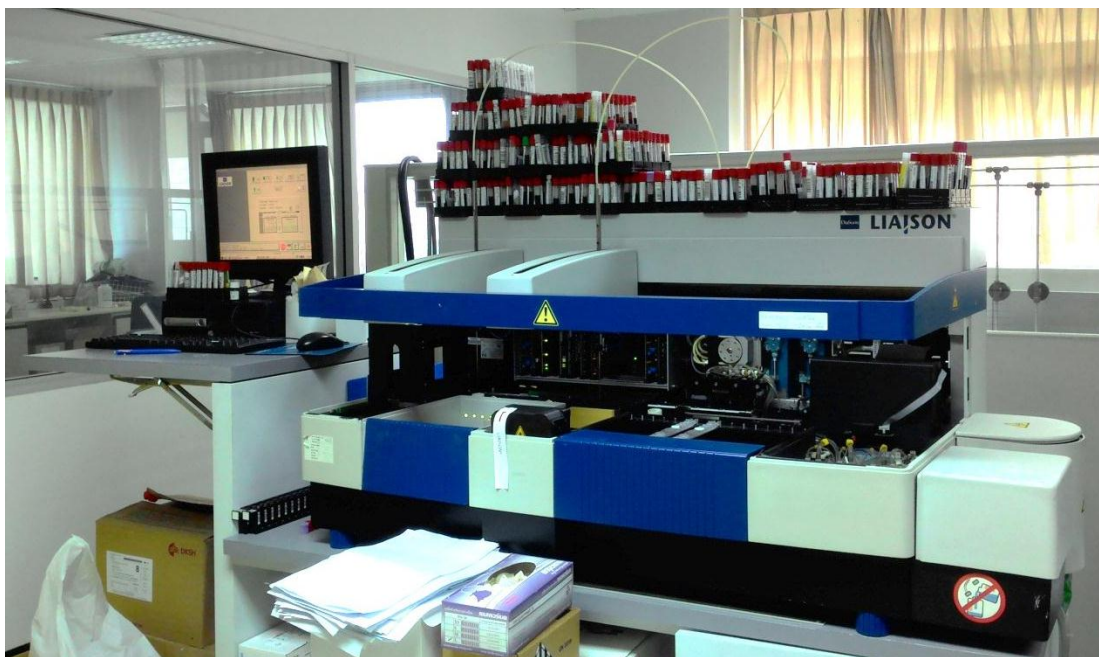
รูปที่ 21 แสดงเครื่องมือ และเครื่องแสดงผล สำหรับการตรวจวัดค่าระดับ 25-hydroxyvitamin D โดยใช้หลักการ chemiluminescence immunoassay (LIAISON, Diasorin Inc.)
