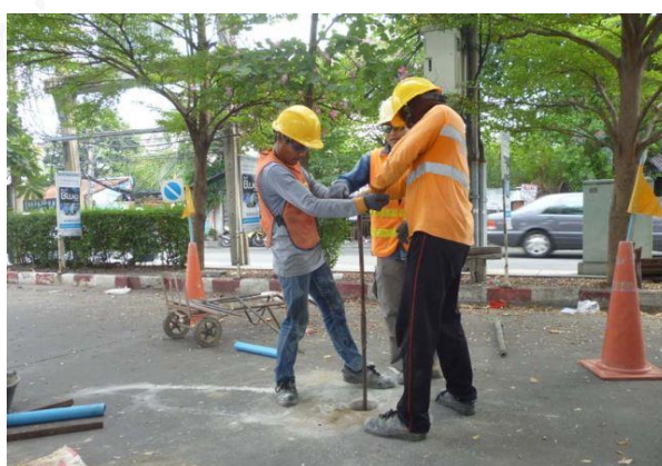
ภาพที่ 4- 7 การเจาะสำรวจเพื่อเก็บตัวอย่างดินกรณีศึกษาที่ 1
