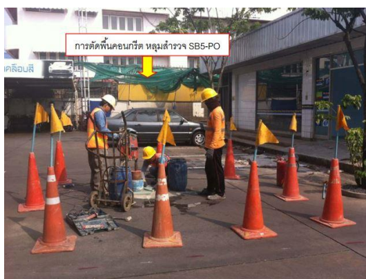
ภาพที่ 4- 15 การเจาะสำรวจดินเพื่อเก็บตัวอย่างดินกรณีศึกษาที่ 2 (ที่มา: บริษัทที่ปรึกษาด้านสิ่งแวดล้อม)
