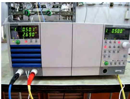
รูปที่ 3.5 เครื่อง Electronic load รุ่น PLZ-30F ของบริษัท KIKUSUI
