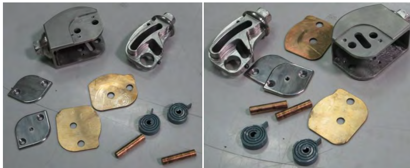
รูปที่ 8.5 แสดงสภาพชิ้นส่วนของกลไกข้อเข้าเทียมหลังทดสอบภาคสนามเป็นเวลา 6 เดือน
