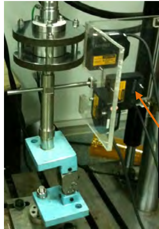
รูปที่ 3.5 อุปกรณ์วัดระยะด้วยแสงเลเซอร์ที่ติดตั้งเพื่อใช้วัดค่ายุบตัวของกลไกข้อเหวี่ยง
