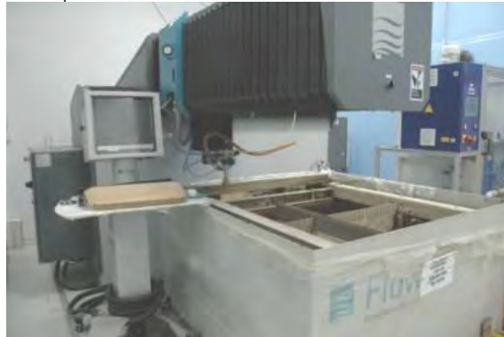
รูปที่ 4.1 เครื่องตัดด้วยน้ำแรงดันสูง (Waterjet Cutting Machine)
