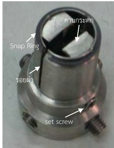
รูปที่ 7.3 ภาพประกอบกลไกขยายขนาดข้อต่อขึ้นล่าง
