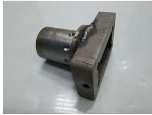
รูปที่ 4.6 อุปกรณ์จับยึดชิ้นงานที่ออกแบบขึ้น
