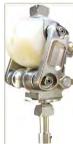
รูปที่ 2.10 กลไกข้อเข้าเทียมพัฒนาโดยบริษัท แอสเซียมเมทอล จำกัด ร่วมกับ เนคเทค/สวทช.
