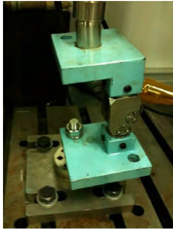
รูปที่ 3.3 กลไกข้อเข้าที่ติดกับเครื่องทดสอบและมีแนวแรงตามมาตรฐานในจังหวะ Toe off
