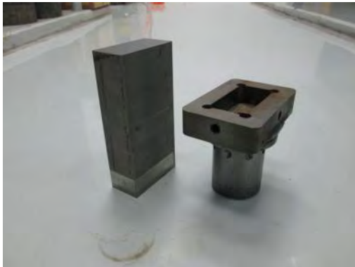
รูปที่ 4.7 การอัดชิ้นงานที่มีหน้าตัดเป็นสี่เหลี่ยมผืนผ้าเข้ากับอุปกรณ์จับยึดชิ้นงาน
