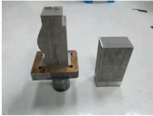
รูปที่ 4.8 การใช้เครื่องตัดด้วยน้ำแรงดันสูง (Waterjet Cutting Machine) เตรียมวัตถุดิบ
