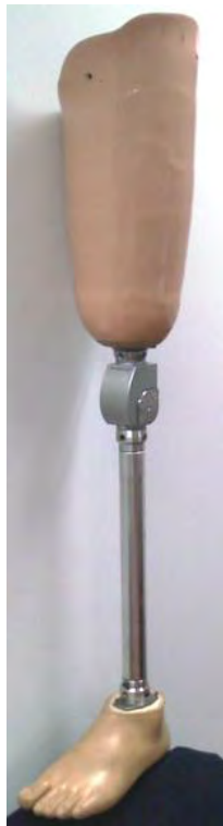
รูปที่ 4.36 กลไกข้อเข่าของขาเทียมเมื่อประกอบเข้ากับเบ้า หน้าแข้ง และเท้า
