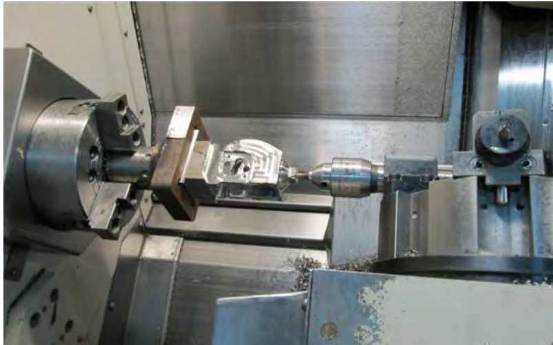
รูปที่ 4.32 ชิ้นส่วนหลักชิ้นนอกหลังขึ้นรูปด้วยเครื่องจักร CNC
