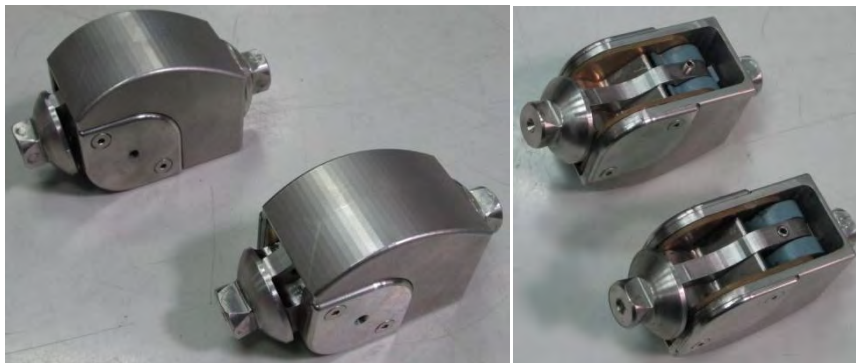
รูปที่ 8.4 ตัวอย่างกลไกข้อเข้าเทียมที่ผ่านการใช้งานมาแล้วเป็นระยะเวลา 6 เดือน
