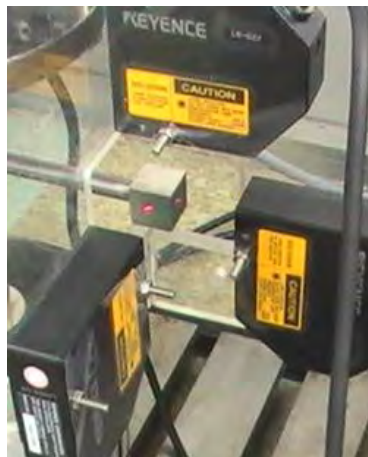
รูปที่ 3.6 ลูกบาศก์ที่ติดอยู่กับก้านที่ยื่นออกมาจากตัวออกแรงกดเพื่อใช้ในการสะท้อนของแสงเลเซอร์ในการวัดระยะยุบตัวทั้งสามแกน
