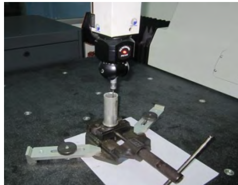
รูปที่ 6.6 การวัดขนาดรูเพลาด้วยเครื่อง CMM
