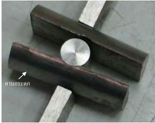
รูปที่ 7.2 กลไกคานกระดกขยายขนาดข้อต่อทำให้ข้อต่อขึ้นล่างและแกนหน้าแข็งเกิดการยึดกันแน่น
