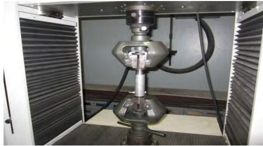
รูปที่ 6.9 การทดสอบแรงกดอัดระหว่างรูเพลากับเพลลาที่ระบบพิกัดความถี่ต่างๆ
