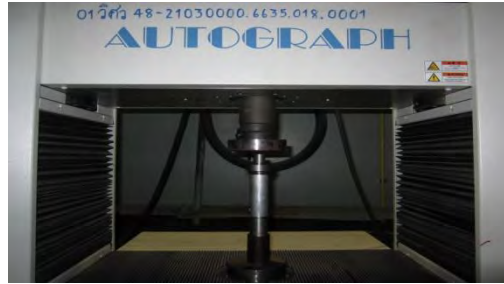
รูปที่ 6.8 การทดสอบแรงกดอัดระหว่างรูเพลากับเพลลาที่ระบบพิกัดความถี่ต่างๆ
