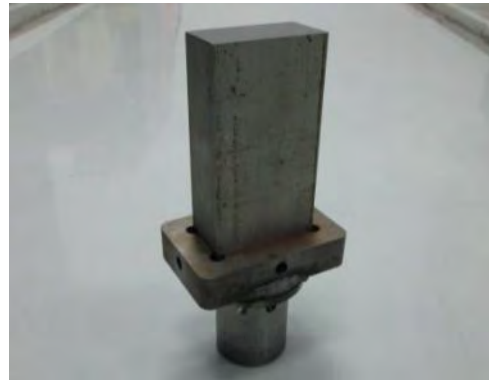
รูปที่ 4.7 การอัดชิ้นงานที่มีหน้าตัดเป็นสี่เหลี่ยมผืนผ้าเข้ากับอุปกรณ์จับยึดชิ้นงาน
