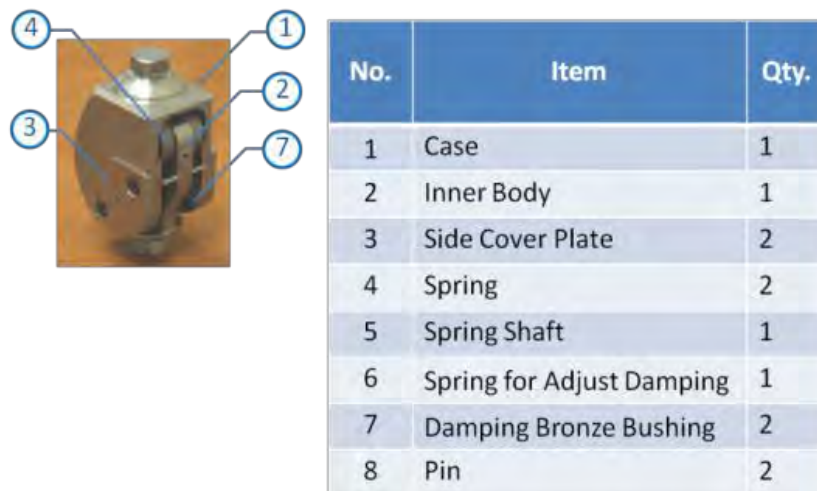
รูปที่ 4.3 ชิ้นส่วนหลักและชิ้นส่วนประกอบอื่นๆ ของข้อเข้าเทียมที่ทีมวิจัยได้พัฒนาขึ้น
