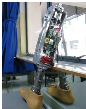
รูปที่ 2.8 ขาเทียมแบบปรับอัตราหมุนวงซึ่งควบคุมด้วยระบบอิเล็กทรอนิกส์
