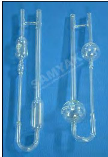
รูปที่ 2.24 Ostwald viscometer (ซ้าย) และ Ubbelohde viscometer (ขวา)
