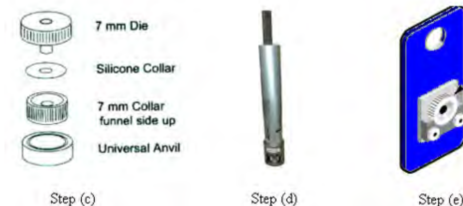
รูปที่ 2.14 เซลล์สำหรับใส่สารตัวอย่างที่เป็นของแข็ง
