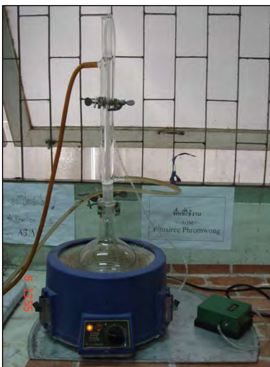
รูปที่ 3.4 การตั้งอุปกรณ์ในการสกัดคอนดรอยทินซัลเฟต
