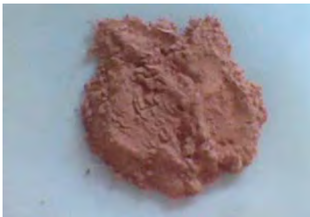
ภาพที่ 4.1 ซิลิกา-อะลูมินาที่ใช้แล้วหลังทำการปรับปรุงเบื้องต้นโดยการบดและ ร่อนผ่านตะแกรงขนาด 200 เมช
