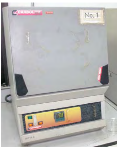
ภาพที่ 3.3 เตาเผาไฟฟ้า (muffle furnace)
