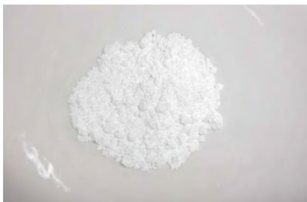
ภาพที่ 4.2 ซิลิกา-อะลูมินาที่ใช้แล้วหลังทำการปรับปรุงเบื้องต้นโดยเผา ที่อุณหภูมิ 700 องศาเซลเซียส เป็นเวลา 3 ชั่วโมง
