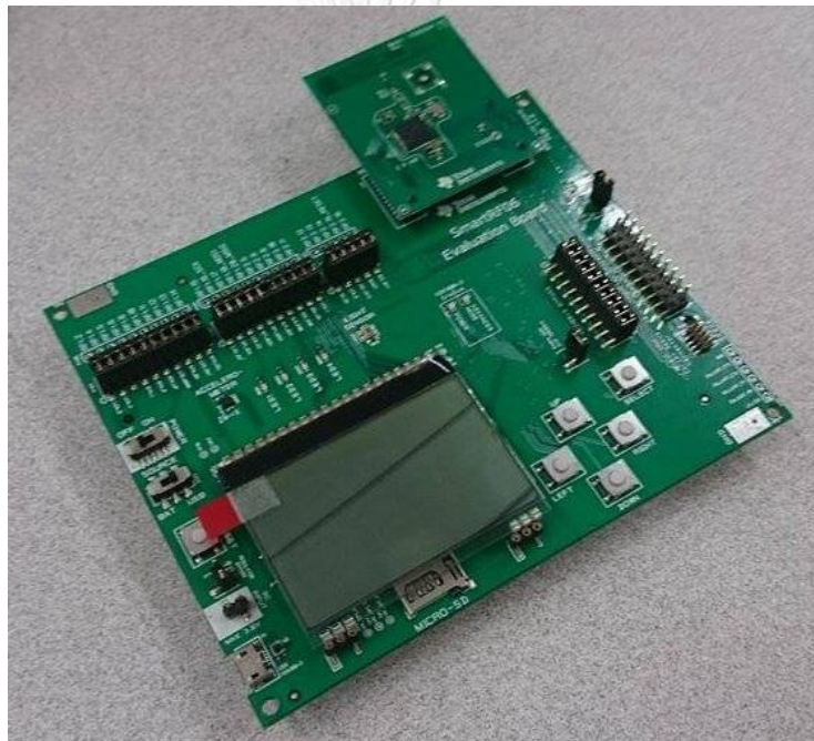
รูปที่ 8 ไมโครคอนโทรลเลอร์ CC2650 และ SmartRF06 Evaluation Board
