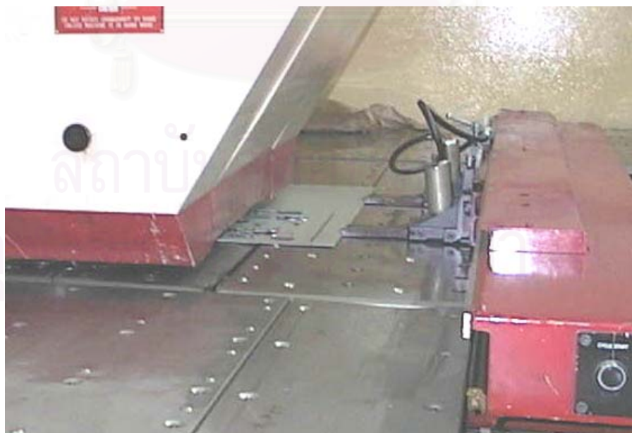
รูปที่ 6.24 ชิ้นงานทดสอบขณะถูกเจาะด้วยเครื่องจักร CNC
