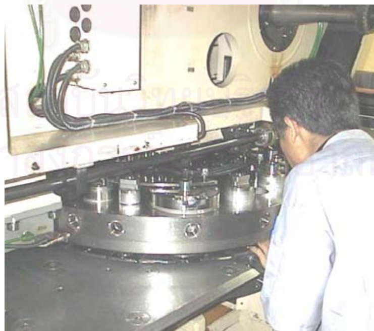
รูปที่ 6.22 การติดตั้งหัวเจาะลงบนแท่นหมุน
