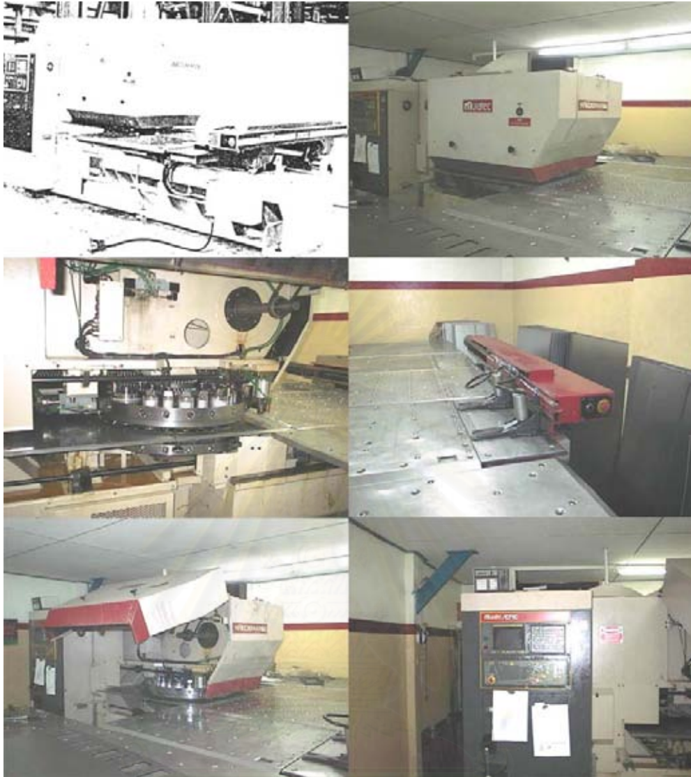
รูปที่ 4.1 เครื่องจักร CNC Turret Punch Press MURATA Centrum 2500
