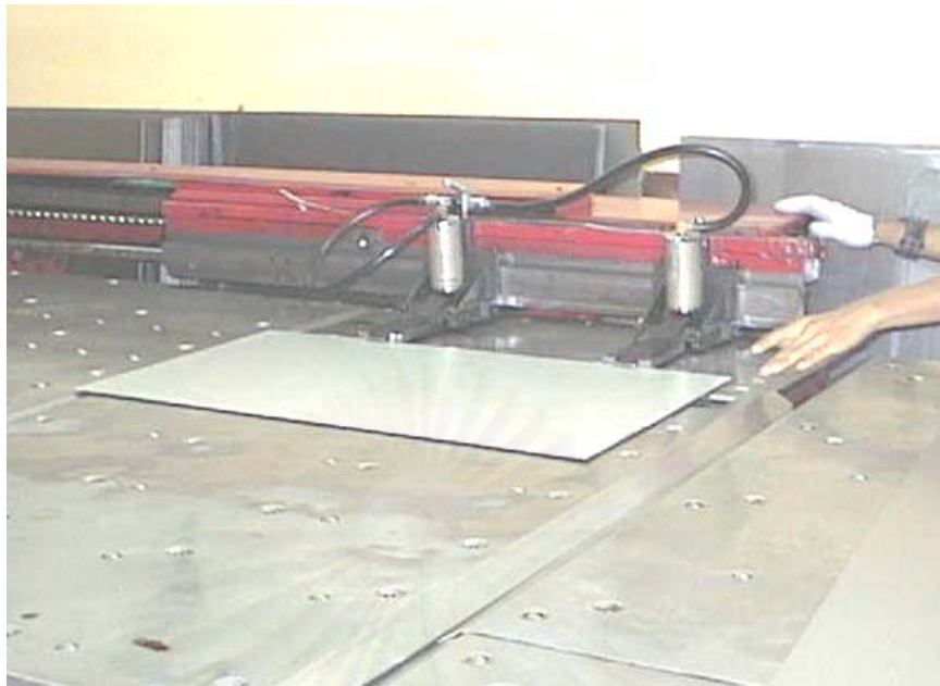
รูปที่ 6.23 การติดตั้งแผ่นโลหะเข้ากับที่จับยึดของโต๊ะ
