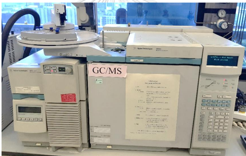
รูปที่ 3.5 เครื่องแก๊สโครมาโทกราฟี ยี่ห้อ Agilent technologies รุ่น 6890 series และเครื่องแมสสเปกโตรมิเตอร์ ยี่ห้อ Agilent technologies รุ่น 5973 series
