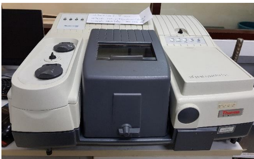
รูปที่ 3.3 เครื่องฟูเรียร์ทรานส์ฟอร์มอินฟราเรดสเปกโทรมิเตอร์ ยี่ห้อ Thermo Scientific รุ่น Nicolet 6700
