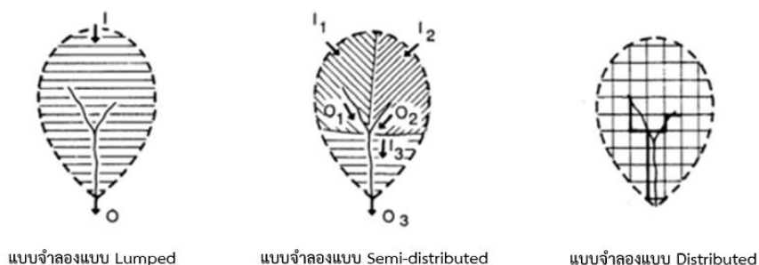
ภาพที่ 2 แบบจำลองแบบ Lumped model (ซ้าย), แบบจำลองรูปแบบ Semi-distributed model (กลาง) และแบบจำลองรูปแบบ Distributed model (ขวา)
