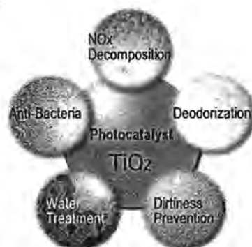
รูปที่ 2.7 การใช้งานของไททาเนียทางด้านการเป็นตัวเร่งปฏิกิริยาด้วยแสง
