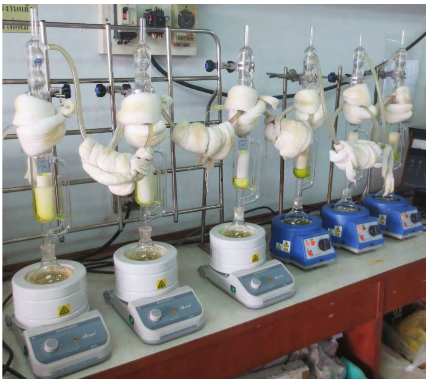
ภาพที่ 4 การสกัดน้ำมันตามวิธี soxhlet
