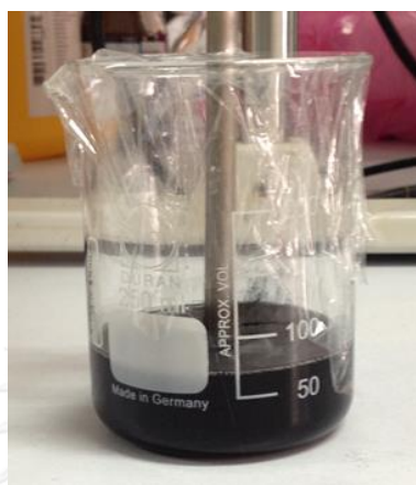
รูปที่ 4.16 ลักษณะของสารเคลือบผิวพอลิยูรีเทนที่ผสมอนุภาคนำไฟฟ้า
