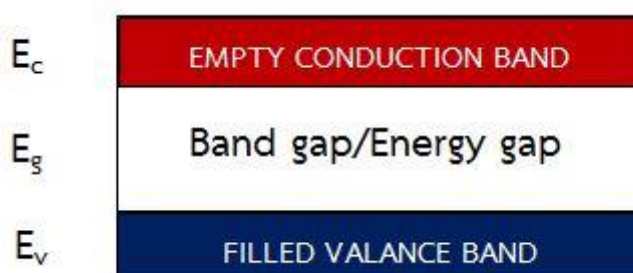
รูปที่ 2.6 รูปแบบทั่วไปของ Energy-band model สำหรับวัสดุกึ่งตัวนำไฟฟ้า
