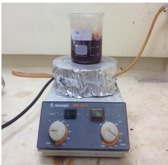
รูปที่ 3.3 การสังเคราะห์อนุภาค P(Py-co-FPy) ที่อุณหภูมิห้อง
