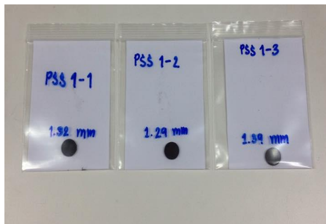
รูปที่ 3.12 ตัวอย่างที่ใช้ในการทดสอบความต้านทานไฟฟ้า
