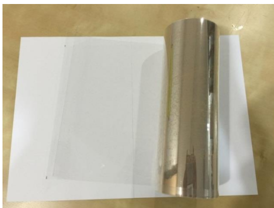
รูปที่ 3.19 แผ่นพลาสติก Polyethylene terephthalate (PET, Melinex 506 ความหนา 180 ไมครอน)
