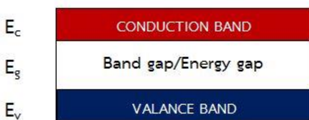
รูปที่ 2.3 รูปแบบทั่วไปของ Energy-band model สำหรับวัสดุนำไฟฟ้า
