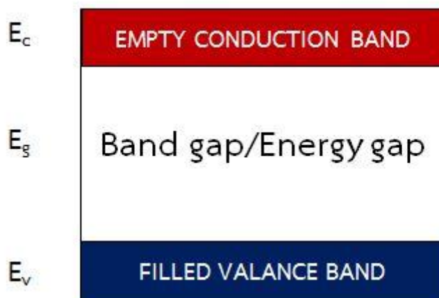
รูปที่ 2.13 รูปแบบทั่วไปของ Energy-band model สำหรับวัสดุนำไฟฟ้า
