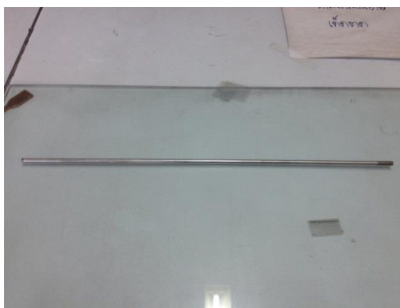
รูปที่ 3.20 เทคนิค Bar coater ในการเคลือบสารเคลือบผิวพอลิยูรีเทน
