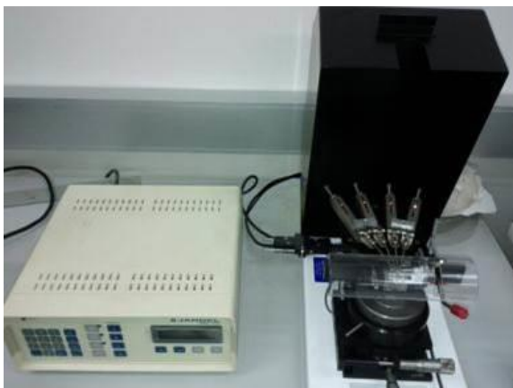
รูปที่ 3.14 เครื่องวัดความต้านทานไฟฟ้า (Four point probe)
