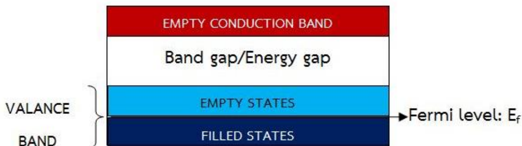
รูปที่ 2.4 ลักษณะ Energy-band model ของวัสดุที่มีการจัดเรียงตัวของอิเล็กตรอนวงนอกสุดแบบ Partial filled
