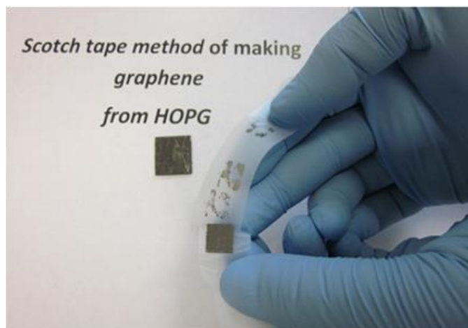
รูปที่ 2.22 การลอกกราฟีนจาก Highly ordered pyrolytic graphite ด้วยวิธีสก็อตเทป [32]
