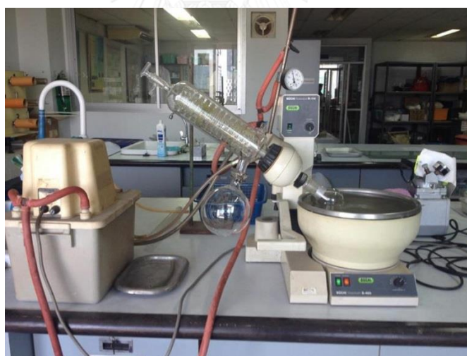
รูปที่ 3.1 ชุดการกลั่นระเหยสารแบบหมุนสำหรับการทำมอนอเมอร์ให้บริสุทธิ์
