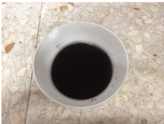
รูปที่ 3.5 อนุภาค P(Py-co-FPy) ขนาด \leq 45 micron
