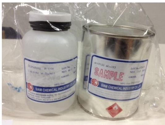
รูปที่ 3.18 แวนิชของ Acrylic polyol เกรด Acrylic AC-333 (ขวา) และเรซิน Isocyanate เกรด Desmodure N-3300 (ซ้าย)
