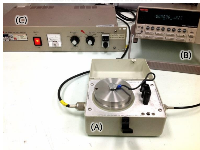
รูปที่ 3.22 เครื่องวัดความต้านทานไฟฟ้าเชิงพื้นผิว (A) Picoammeter (Model 6485, Keithley) (B) Resistivity adapter (Model 6105, Keithley) (C) High voltage supply (Keithley 247)
