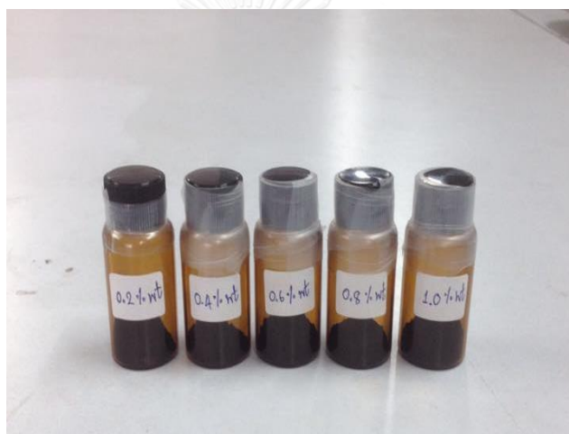
รูปที่ 3.17 ตัวอย่างที่ใช้ในการทดสอบด้วยเทคนิคเทอร์โมกราวิเมตริก
