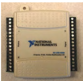
รูปที่ 4.8 อุปกรณ์รับและส่งข้อมูล DAQ รุ่น NI USB-6008
