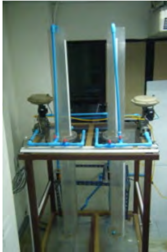
รูปที่ 4.2 ถังควบคุมระดับน้ำ
