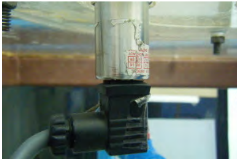
รูปที่ 4.3 อุปกรณ์วัดระดับน้ำ (Pressure Transmitter
