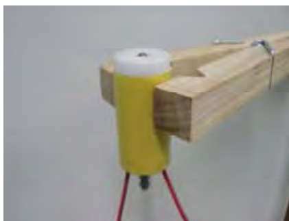
ภาพที่ 3.10 โปรบที่ใช้เทฟลอนเป็นวัสดุไดอิเล็กทริก
