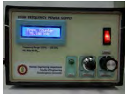
ภาพที่ 3.6 แหล่งจ่ายไฟฟ้ากระแสสลับแรงดันสูงความถี่สูง
