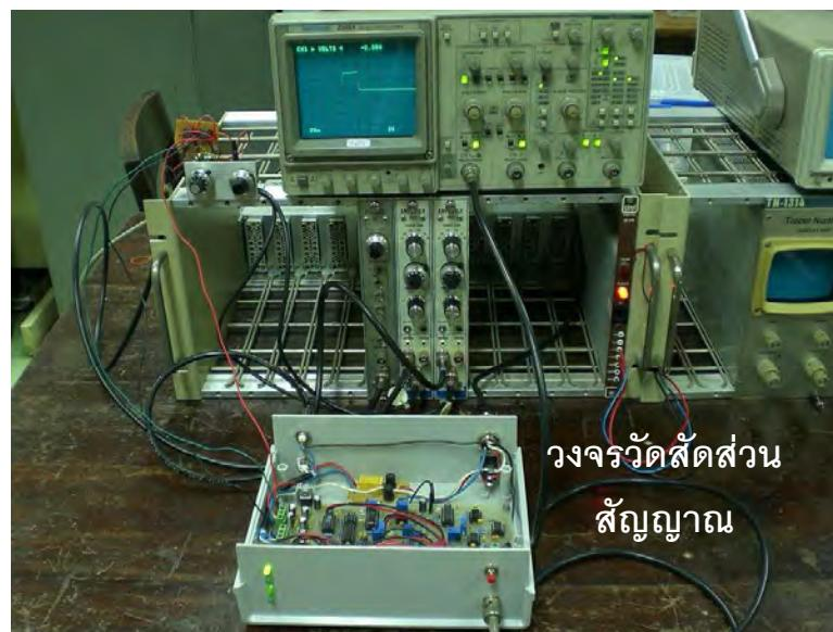
ภาพที่ 4.15 การจัดอุปกรณ์ทดสอบการทำงานของวงจรหารสัญญาณ
