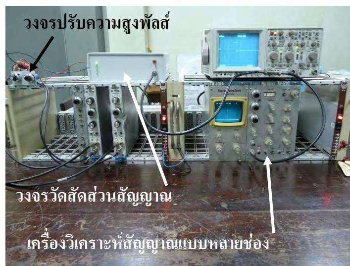
ภาพที่ 4.18 การจัดอุปกรณ์ทดสอบระบบวัดตำแหน่งสัดส่วนสัญญาณ
