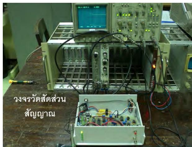
ภาพที่ 4.11 การจัดอุปกรณ์ทดสอบวงจรตรวจจับสัญญาณพัลส์
