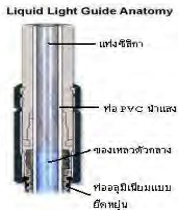
ภาพที่ 2.12 โครงสร้างของท่อน้ำแสงชนิดของเหลว
