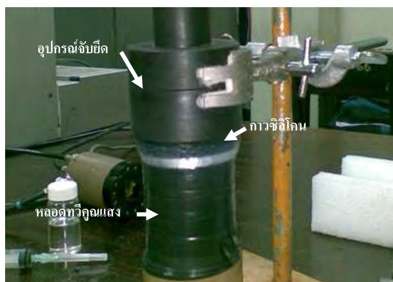
ภาพที่ 3.7 การประกอบอุปกรณ์เชื่อมต่อด้านหลอดทวีคุณแสง
