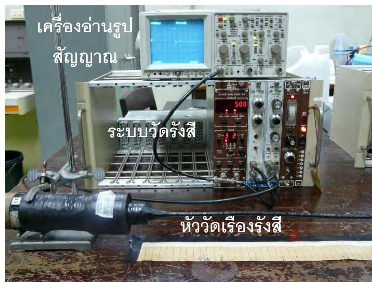
ภาพที่ 4.2 การจัดระบบวัดรังสีเพื่อทดสอบหัววัดเรืองรังสีแบบท่ออ่อนแกนเดียว
