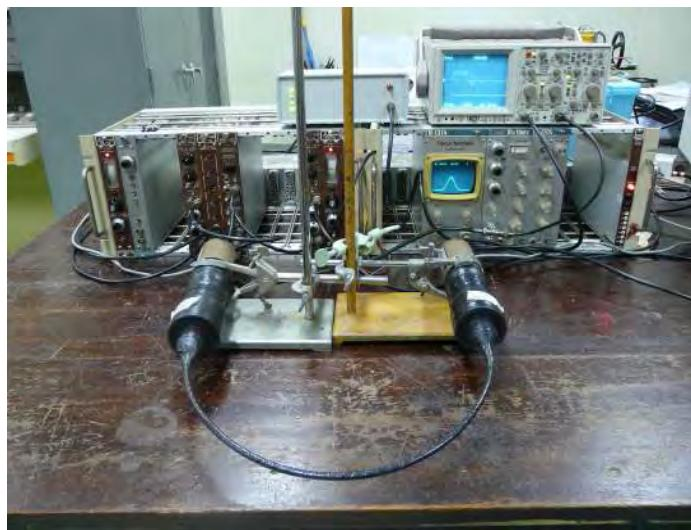
ภาพที่ 4.31 การจัดระบบวัดรังสีเพื่อทำการทดสอบหัววัดรังสีแบบไวต่อตำแหน่งในแนวโค้งรูปตัวยู
