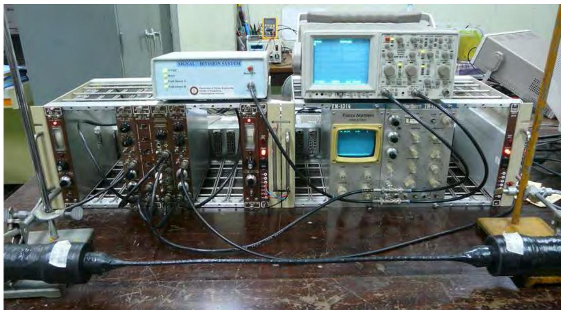
ภาพที่ 3.20 ระบบวัดสัดส่วนสัญญาณเต็มระบบที่พัฒนาขึ้น
