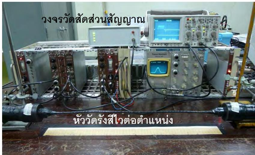
ภาพที่ 4. 22 การจัดระบบวัดรังสีเพื่อทำการทดสอบหัววัดรังสีแบบไวต่อตำแหน่ง
