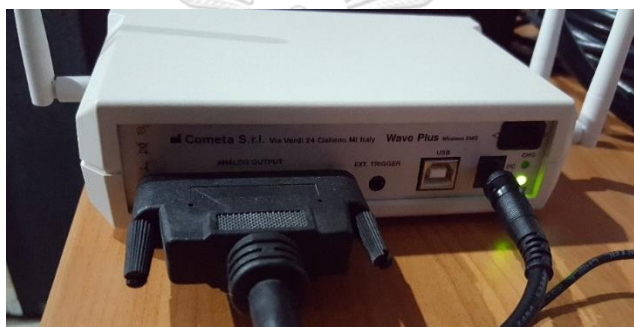
รูป ช่องอ่านการ์ด SD (อุปกรณ์เสริม), ตัวต่อสัญญาณส่งออก, สัญญาณกระตุ้นจากภายนอก, ช่องต่อ USB, ปลั๊กไฟ, CHG, Line, ปุ่มเปิด/ปิดของตัวรับสัญญาณหลัก (ด้านหลัง)
