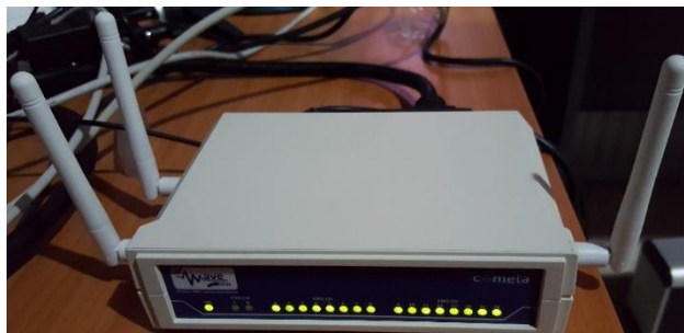
รูป ตัวรับสัญญาณหลัก (ด้านหน้า) มีสัญญาณไฟ Led เปิด และไฟ Led แสดงสถานะของอิเล็กทรอนิกส์
