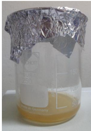
3)สารละลายไฟโบรอินในตัวทำละลายลิเทียมโบร ไมด์
