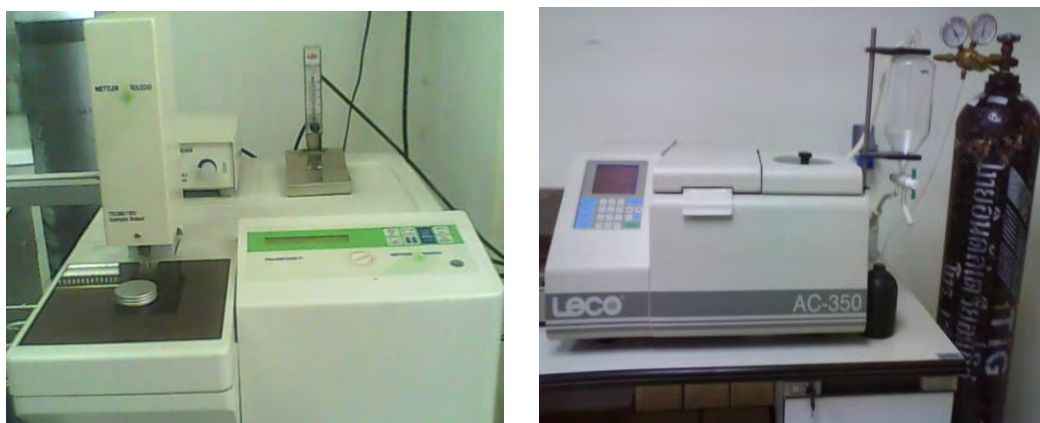
รูปที่ 3.2 เครื่องเทอร์โมกราวิเมตริก (TGA) สำหรับการวิเคราะห์ลักษณะสมบัติของพลาสติกแบบประมาณ และเครื่องวิเคราะห์ค่าความร้อน
