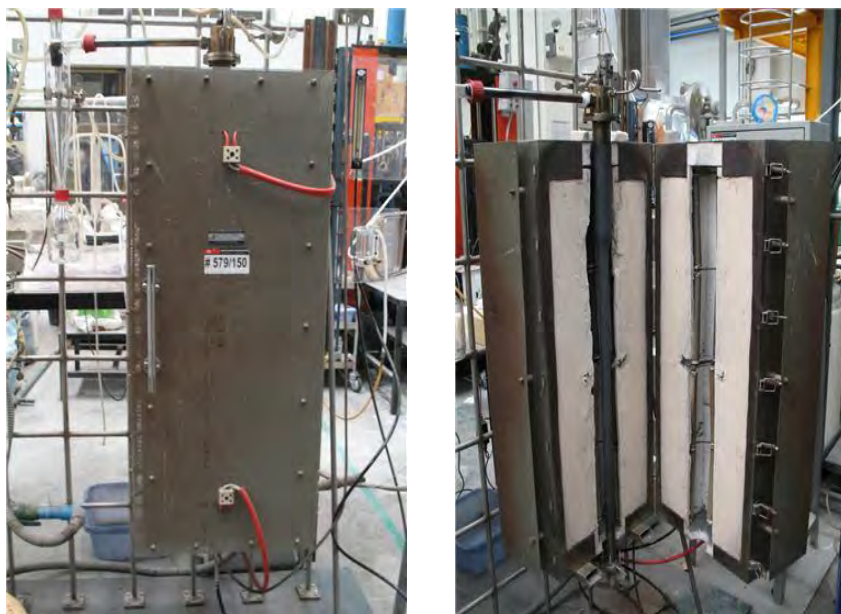
รูปที่ 3.4 เครื่องปฏิกรณ์ที่ประกอบเข้ากับเตาไฟฟ้าให้ความร้อน
