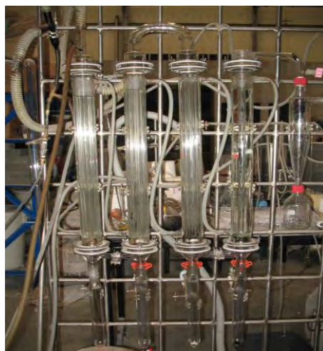
รูปที่ 3.5 เครื่องวิเคราะห์ร้อยละแก๊สผลิตภัณฑ์ที่ได้จากปฏิกิริยาและอุปกรณ์ ควมแน่นผลิตภัณฑ์เหลว
