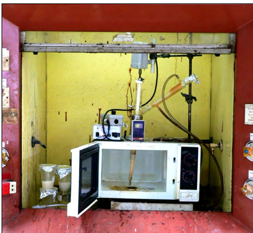
รูปที่ 3.1 ชุดเตาปฏิกรณ์ไมโครเวฟที่ใช้ในการย่อยสลายเพ็ด
