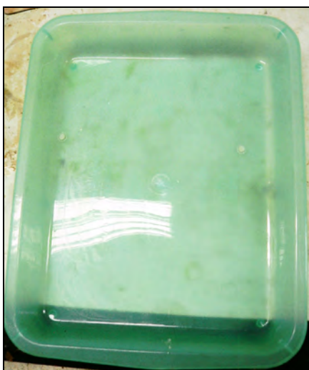
รูปที่ 4.7 พอลิยูรีเทนที่เตรียมได้จากกระบวนการเกิดพอลิเมอร์แบบสารละลาย
