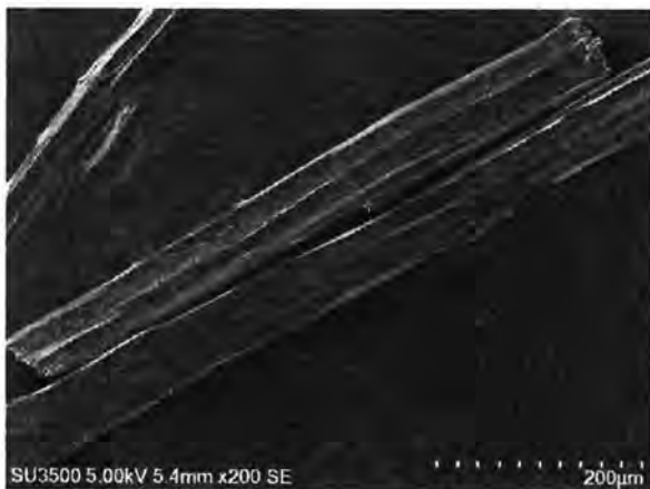
รูปที่ 3 สัณฐานวิทยาของเส้นใยปอแก้ว (KF) ที่กำลังขยาย 200 เท่า (ซ้าย) และ 1,000 เท่า (ขวา)
