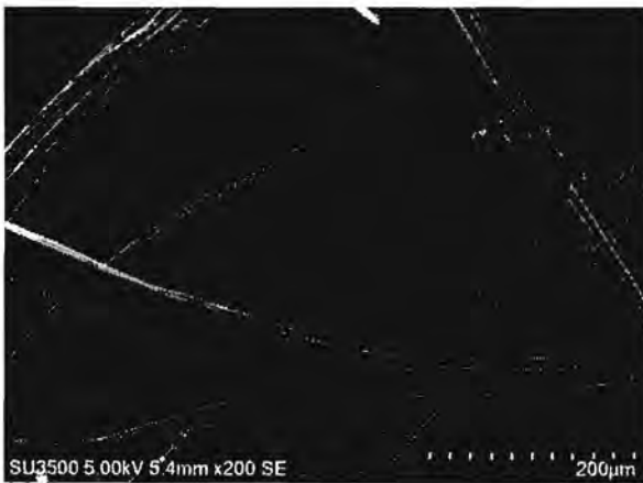
รูปที่ 9 สัณฐานวิทยาของเส้นใยพอลิเอทิลีนที่ผ่านการทำอัลคาไลน์ที่รีทเม้นท์ด้วยโซเดียมไฮดรอกไซด์เข้มข้น 17.5% และตามด้วยการฟอกขาว (KF-T17.5-B) ที่กำลังขยาย 200 เท่า (ซ้าย) และ 1,000 เท่า (ขวา)
