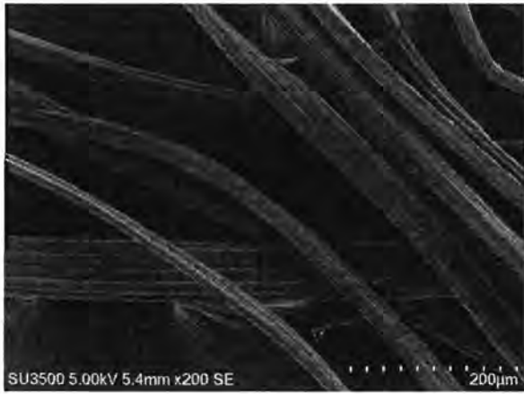
รูปที่ 8 สัณฐานวิทยาของเส้นใยพอลิเอทิลีนที่ผ่านการทำอัลคาไลน์ที่รีทเม้นท์ด้วยโซเดียมไฮดรอกไซด์เข้มข้น 12% และตามด้วยการฟอกขาว (KF-T12-B) ที่กำลังขยาย 200 เท่า (ซ้าย) และ 1,000 เท่า (ขวา)
