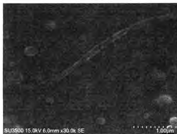
รูปที่ 11 สัณฐานวิทยาของเส้นใยปอแก้วที่ผ่านการทำอัลคาไลน์ทรีทเมนต์ด้วยโซเดียมไฮดรอกไซด์เข้มข้น 12% และตามด้วยกระบวนการเตรียมเยื่อ และไฮโดรลิซิสด้วยกรด (KF-T12-M-A60) ที่กำลังขยาย 30,000 เท่า
