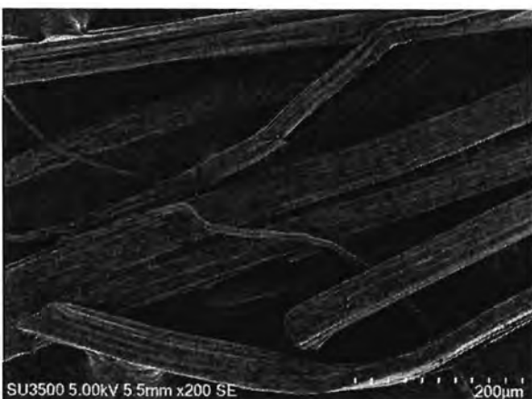
รูปที่ 7 สัณฐานวิทยาของเส้นใยปอแก้วที่ผ่านการทำอัลคาไลน์ทรูทรีเมนต์ด้วยโซเดียมไฮดรอกไซด์เข้มข้น 4% และตามด้วยการฟอกขาว (KF-T4-B) ที่กำลังขยาย 200 เท่า (ซ้าย) และ 1,000 เท่า (ขวา)
