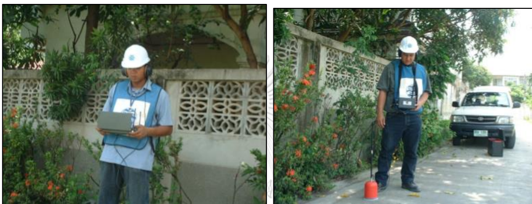
ภาพที่ 2 การใช้เครื่องมือหาจุดที่น้ำรั่วไหล (ศักดิ์ชัย หอมกระแจะ, ม.ป.ป.)
