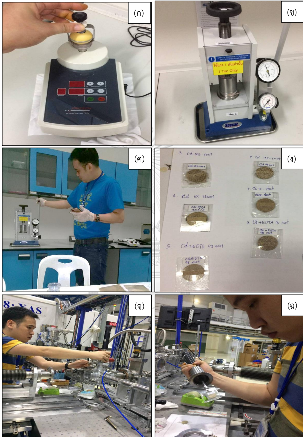
รูปที่ ก3 (ก) การผสมสารอ้างอิงด้วยเครื่องผสมตัวอย่าง (ข) เครื่องอัดเม็ดตัวอย่าง (ค) กระบวนการอัดเม็ดตัวอย่างโดยเพิ่มเป็นลำดับขั้น (ง) การเตรียมตัวอย่างในห้องใส่ตัวอย่าง
