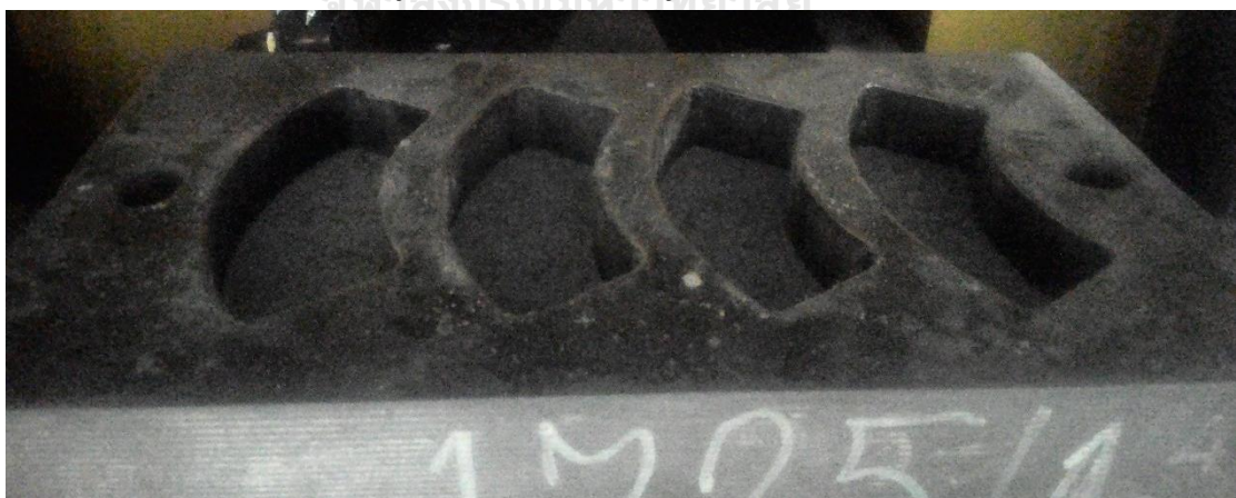
รูปที่ ข.2 ความสูงของแต่ละหลุมแม่พิมพ์อัดขึ้นรูปเย็นหลังเกลี่ยด้วยระยะกดตัดยอด
