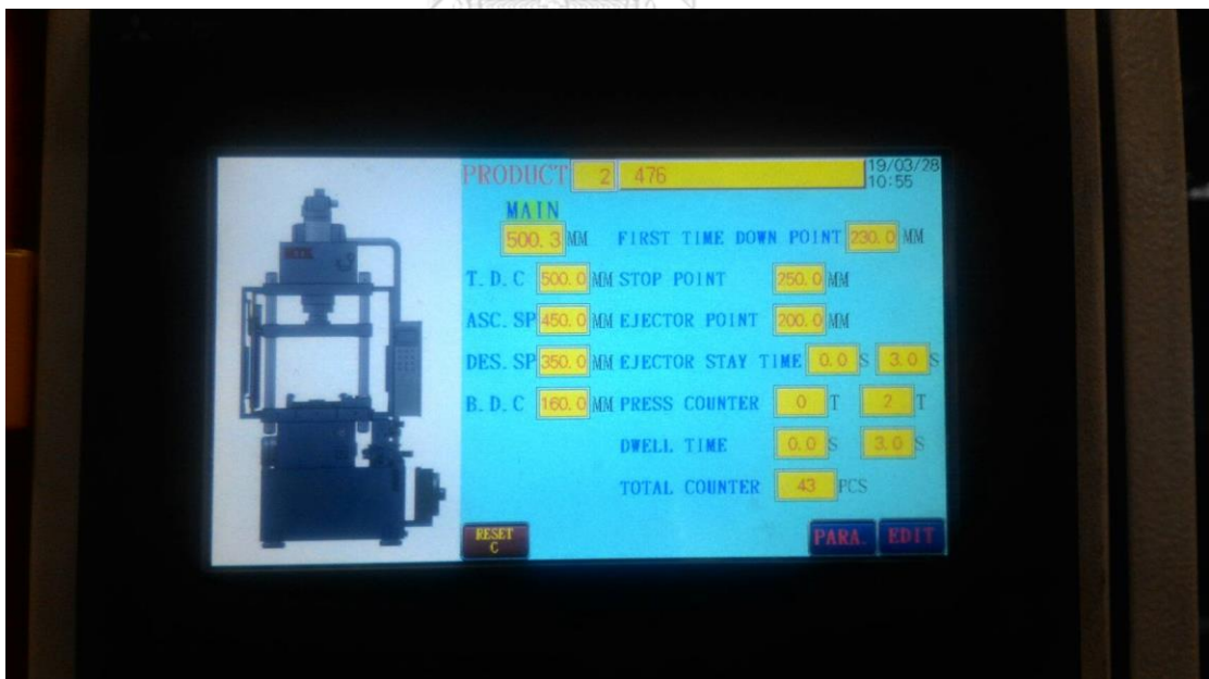
รูปที่ ข.4 หน้าจอแสดงผลการควบคุมเครื่องอัดขึ้นรูปเย็นที่ระยะกด และเวลาการอัด
