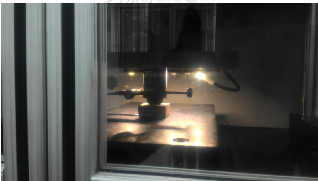
รูปที่ ข.11 เครื่องทดสอบชิ้นงานอัดขึ้นรูปร้อนด้วยเครื่องเสียงความถี่สูง (Ultrasonic measurement)
