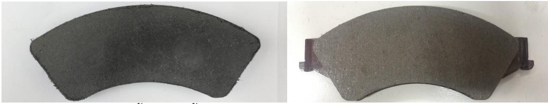
รูปที่ ข. 7 ชิ้นงานอัดขึ้นรูปร้อน (ซ้าย) แบบไม่ติดเหล็ก (ขวา) แบบติดเหล็ก
