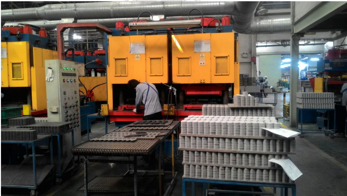
รูปที่ ข.6 เครื่องอัดขึ้นรูปแบบร้อน
