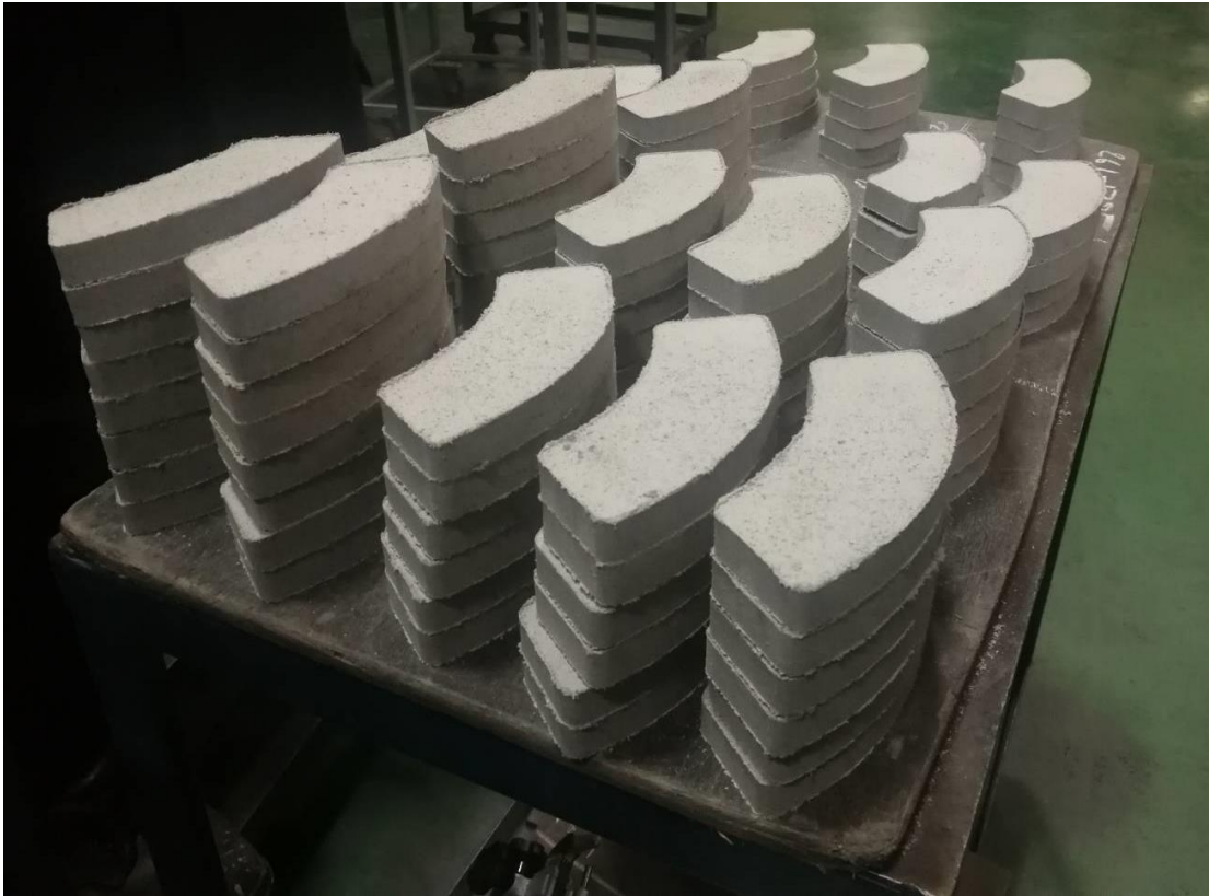
รูปที่ ข.5 ชิ้นงานอัดขึ้นรูปเย็นจากเครื่องอัดขึ้นรูปแบบใหม่
