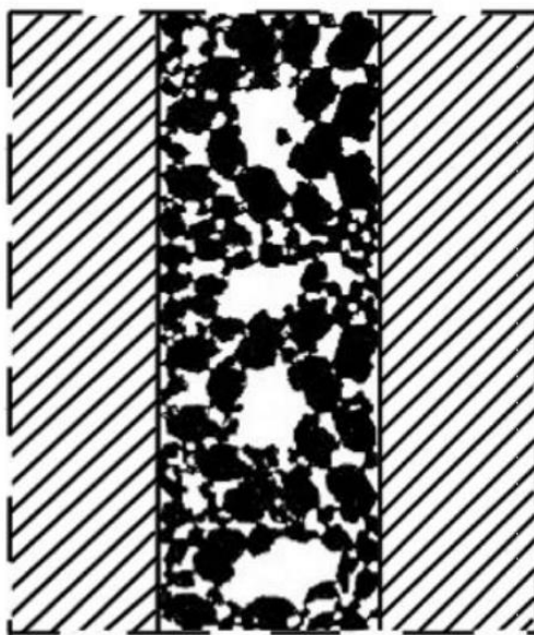
รูปที่ 3.6 การเรียงตัวของสะพานเคมีผสมในแม่พิมพ์[32]
