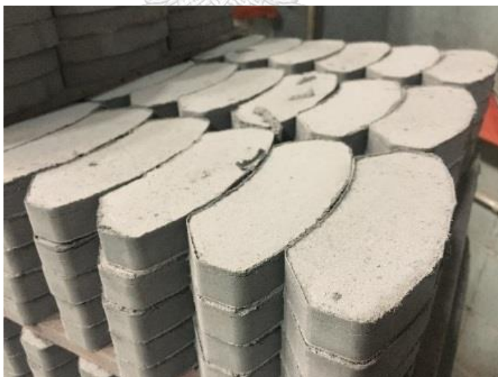
รูปที่ 19 ขึ้นงานผ้าเบรกลหลังอัดขึ้นรูปพิมพ์เยื่อ
