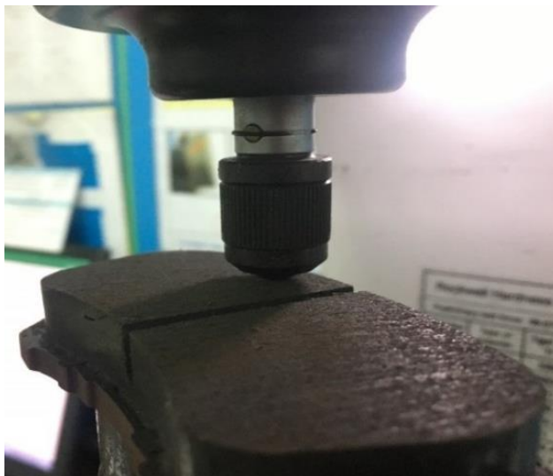
รูปที่ 21 การทดสอบความแข็งของผ้าเบรกตามมาตรฐาน JIS D4421
