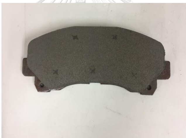
รูปที่ 22 ตำแหน่งการวัดค่าความแข็งบนผิวหน้าผ้าเบรก
