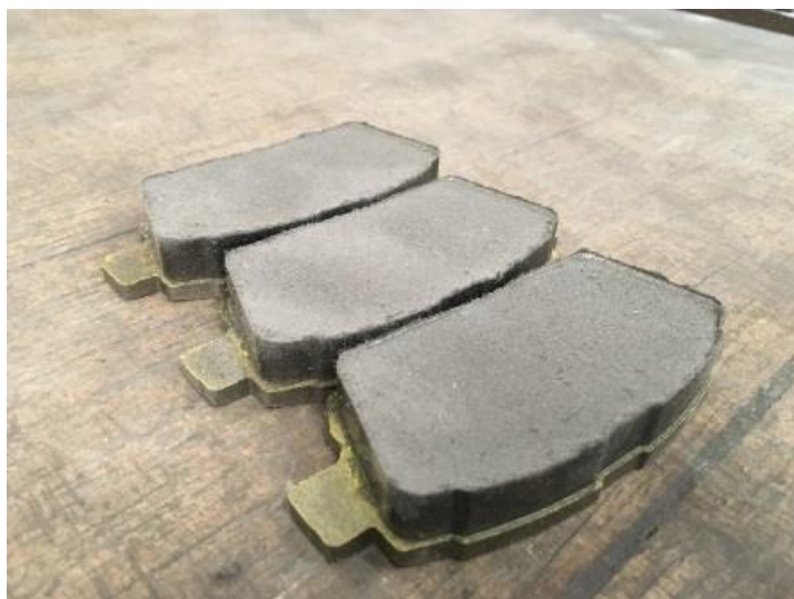
รูปที่ 20 ชิ้นงานผ้าเบรกหลังอัดขึ้นรูปพิมพ์ร้อน
