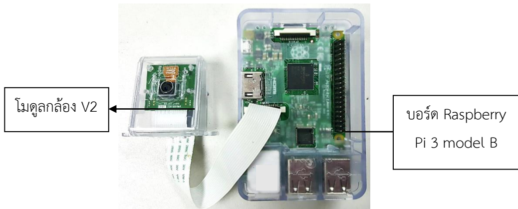
รูปที่ 3.2 บอร์ด Raspberry PI 3 model B และโมดูลกล้อง V2
