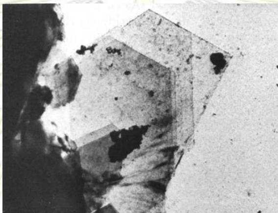
รูปที่ 1.2 ผลึกแกรไฟต์ที่สังเคราะห์จาก MgCl_2 และ CaC_2
