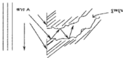
รูปที่ 2.13 การแพร่ของสารตั้งต้นเข้าไปภายในรูพรุนของตัวเร่งปฏิกิริยาวิธพ่น
